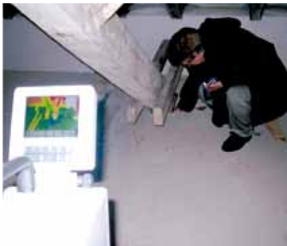
Qualitätssicherung hinsichtlich Wärmebrücken und Luftdichtheit
