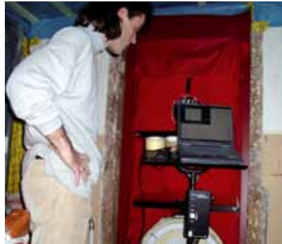
Blower-Door-Test: Bei Unter-/Überdruck wird der Volumenstrom pro Stunde gemessen.
