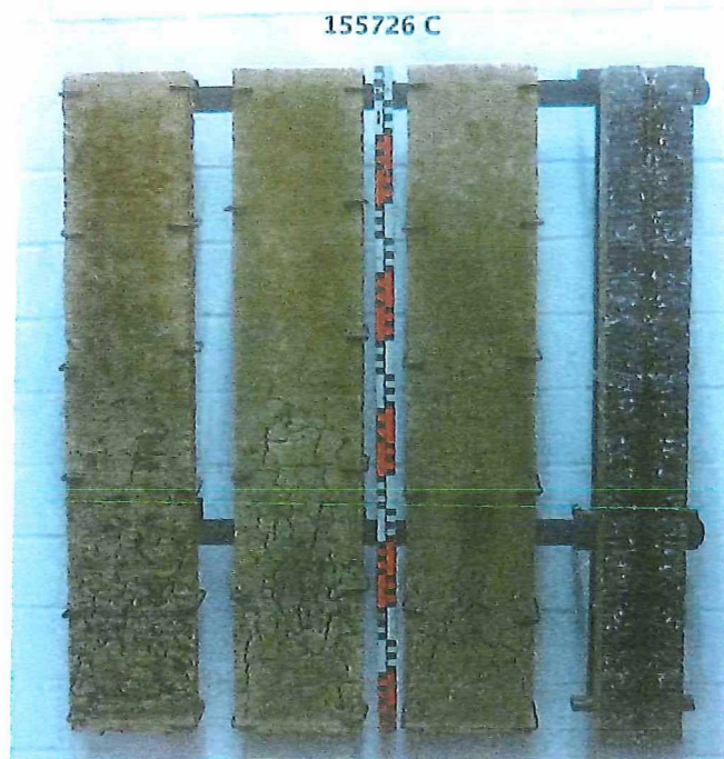
Bild 5: Aussehen des Probekörpers C nach 10-minütiger Beflammung
