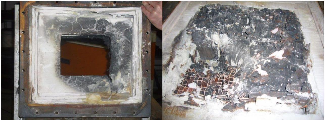
**Bild 2:** Faserzustellung (links) und Verstopfung der Waben (rechts) im Regeneratorkopf
