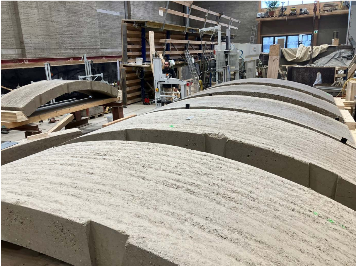
9 Zwischengelagerte Bögen für die Bauteilversuche
