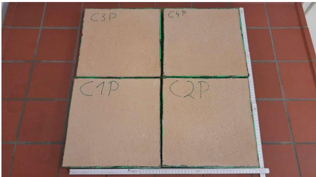
Die Probekörper hatten ein Format von etwa DIN A4. Die Massendifferenz zwischen Adsorption und Desorption von 10 g bezieht sich auf eine Fläche von nur rund 0,06 m<sup>2</sup>. Hochskaliert auf 1 m<sup>2</sup> errechnet sich eine Feuchtepufferung von ca. 160 g in einem Zyklus.
