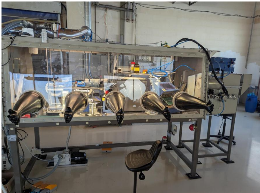
Abb.4 Ar-Glovebox für die Herstellung von Natrium-Ionen-Batterien
