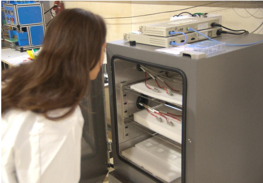
Abb.10 Messung der Knopfzellen im Klimaschrank.
