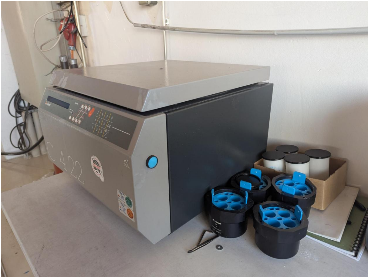
Abb.11 Zentrifuge für Probenröhrchen von 32x10ml, 12x50ml, 4x400ml und 4x700ml
