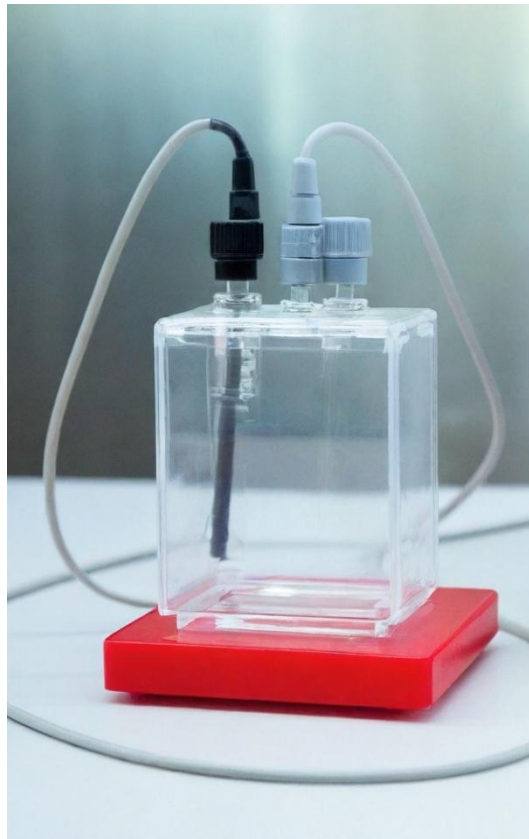
Abb.5 Vorrichtung für die Herstellung von PEDOT:NaCl per Elektropolymerisation beschichteten Elektroden
