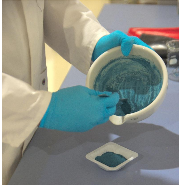
Abb.6 Zerkleinerung des fertigen filtrierten und gewaschenen Pulvers mit einem Mörser.
