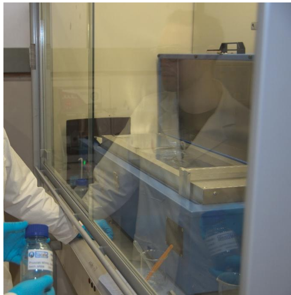
Abb.2 Tischabzug mit Elektrodenbeschichtungsgerät
