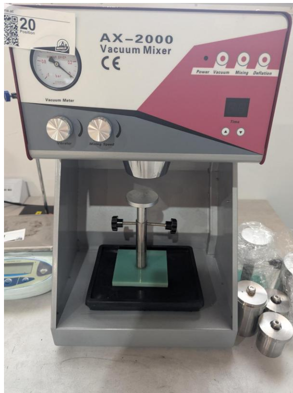
Abb.1 Vakuummischer für Batterieslurries
