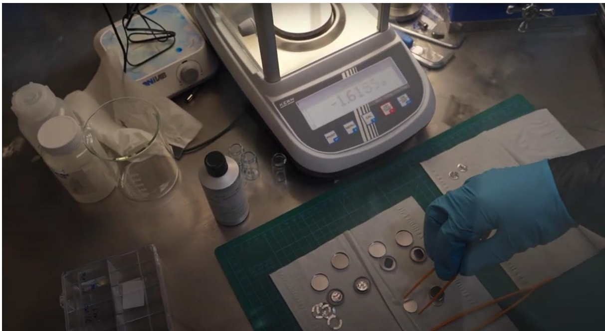
Abb.8 Aufbau der CR2032 Knopfzellen für das Kathodenscreening.
