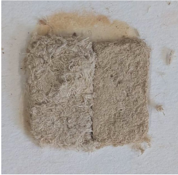
Abbildung 8 links: nicht gefestigt, rechts: gefestigt.
