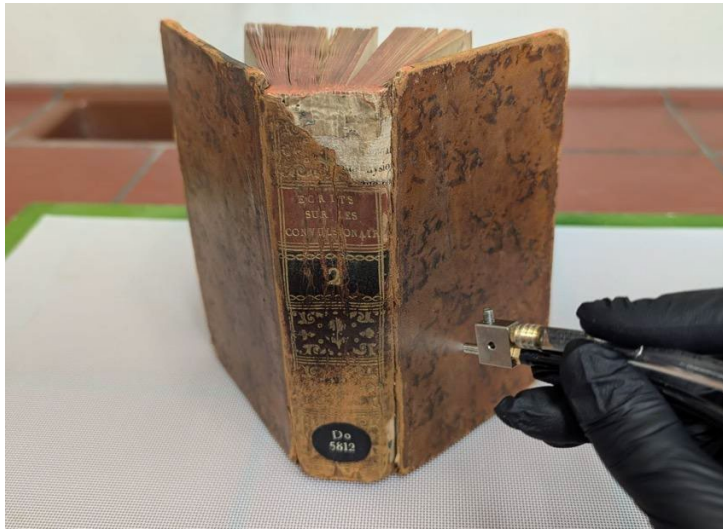
Abbildung 14 Auftrag des Aerosols mithilfe des Zwerg-Zerstäubers an einem originalen Band.
