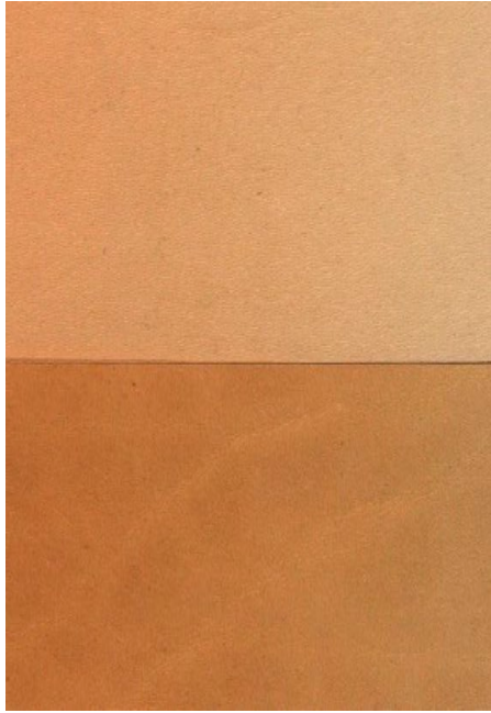
Abbildung 4 oben: ungealtertes Leder, unten: gealtertes Leder nach Hitze- und Klimaalterung.
