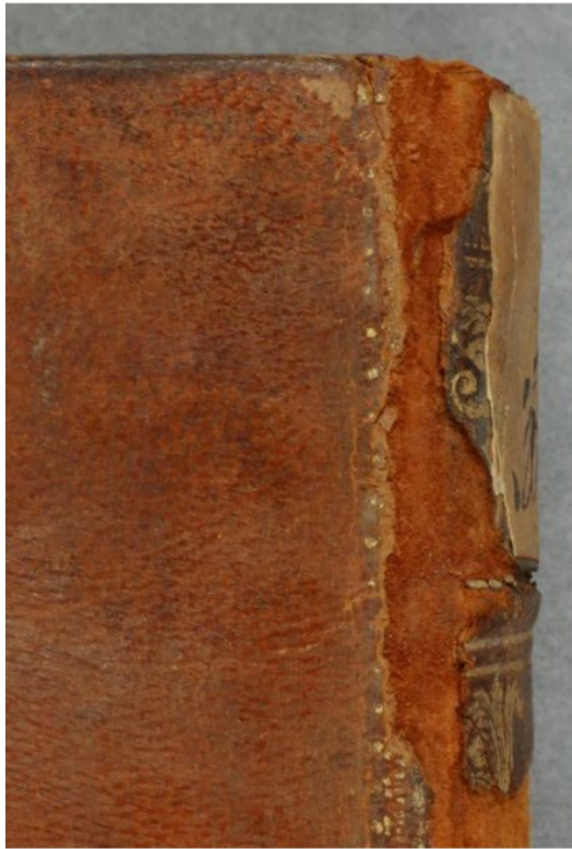
Abbildung 1 Buch mit rotem Zerfall, zu erkennen an der roten pudrigen Oberfläche
