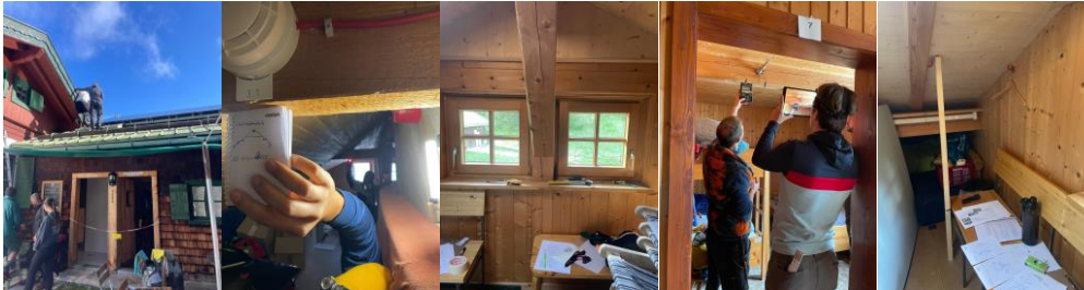
Abbildung 7: Durchführung der Bestandsaufnahme und Identifikation der Bauteile, Messung der Holzfeuchte sowie Probenahme für Laboruntersuchungen
