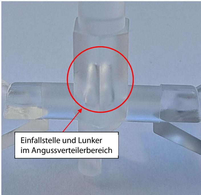
Abbildung 17: Sichtbare Einfallstelle und Lunker im Angussverteilerbereich
