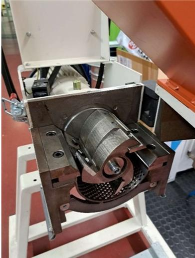
Abbildung 12: Verwendete Schneidmühle zur Mahlgutgenerierung
