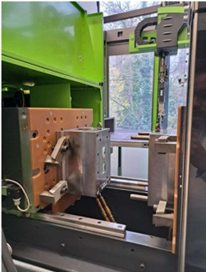
Auf der Spritzgussmaschine (Engel e-motion 50t) verbautes Werkzeug
