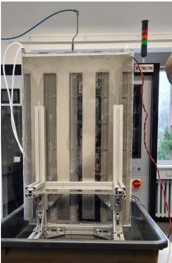
Abb. 27: 3C-SiC-Photokatalysezellen-Prototyp mit Gasableitung, Elektrolytkreislauf und Stromsensoren.
