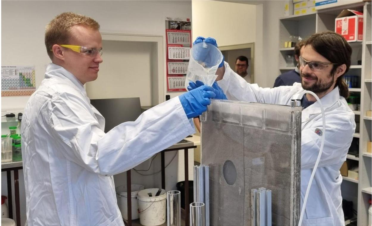
Abb. 28: Befüllung des Prototypen mit Elektrolyt.
