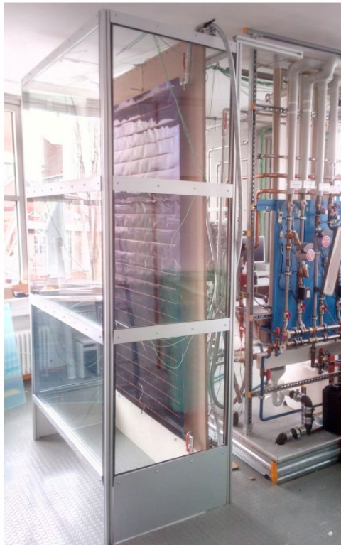
Abb. 17: Solarkamin, Prototyp im Labor (Hochschule München)[6]
