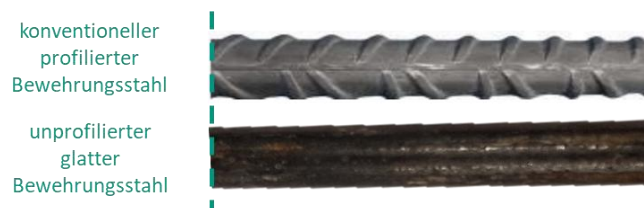
Anhang A1 3-13: Unterschiedliche Stahlarten im Vergleich [Foto Stöhr]
