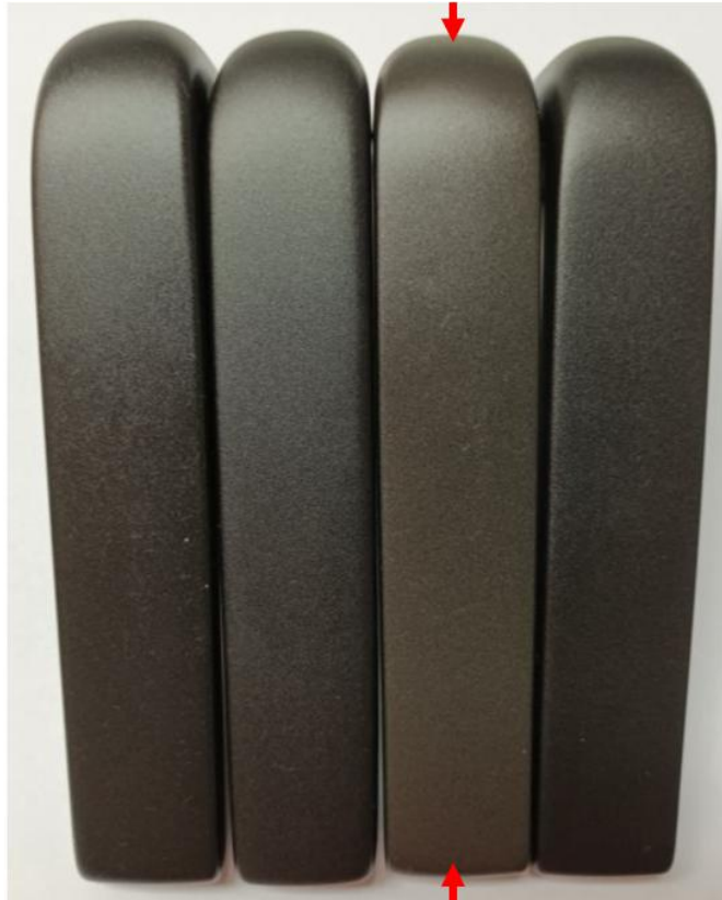
Abbildung 8: Farbabweichung der mit roten Pfeilen gekennzeichneten Probe aus der Charge mit Zugabe von Mg, Mn, Cr, Cu, Fe, Si und Zn im Vergleich zu akzeptierten Proben.
