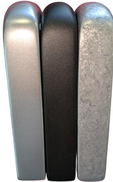
Abbildung 4: Beispiel der drei hergestellten Oberflächen. Naturanodisiert (links), schwarzanodisiert (mitte) und mechanisch bearbeitet (rechts).
