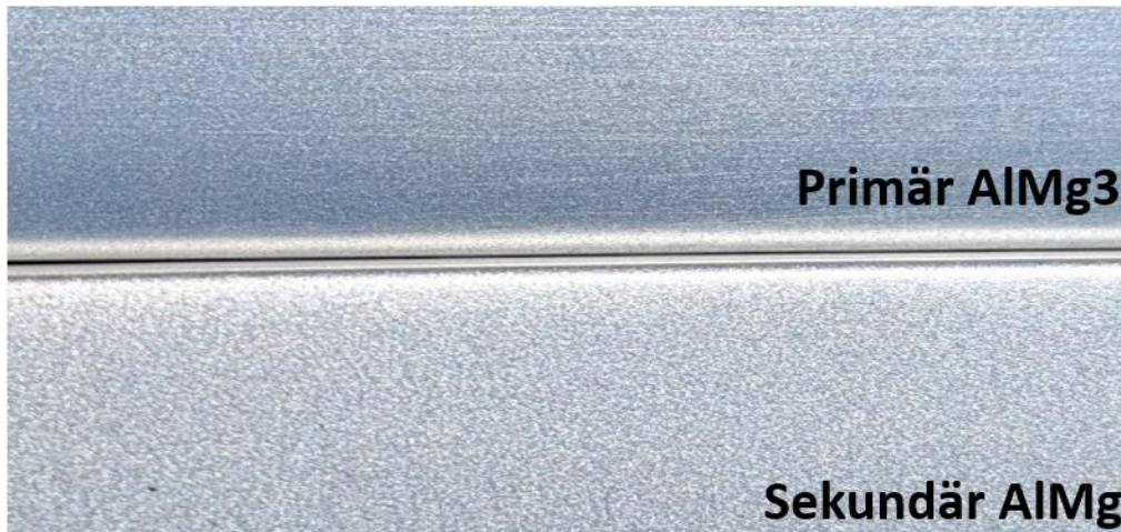
Abbildung 10: Vergleich zwischen einer Kontrollprobe (Primär AlMg3) und einer Probe aus der ersten Versuchsreihe zu den ungelösten Verunreinigungen.
