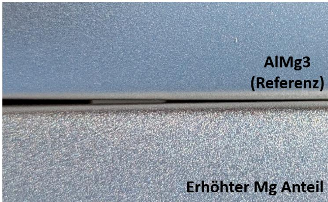
Abbildung 5: Vergleich zwischen C1 (Referenzprobe) und einer Probe aus der Mg-Charge mit erhöhtem Mg-Anteil für die naturanodisierte Oberfläche.
