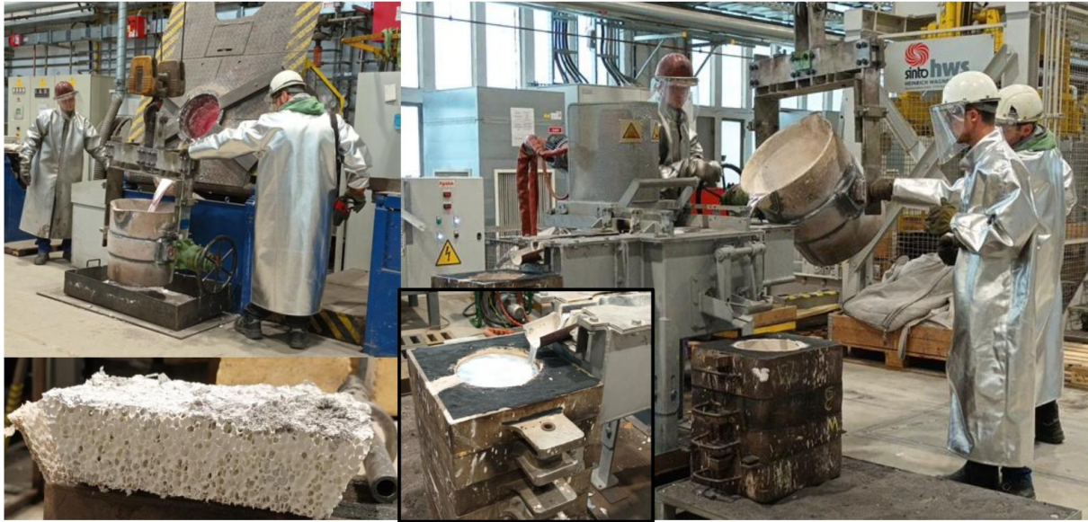
Abbildung 9: Überführung der Schmelze vom Induktionsofen in die Gießpfanne (oben links), Schaumkeramikfilter nach der Filtration (unten links), gefiltertes Material in der Form (mitte), Abgießen in der Filtrationsanlage (rechts).
