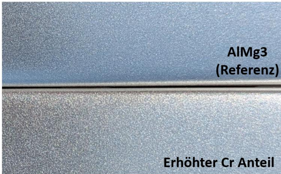
Abbildung 6: Vergleich zwischen C1 (Referenzprobe) und einer Probe aus der Cr-Charge mit erhöhtem Cr-Anteil für die naturanodisierte Oberfläche.
