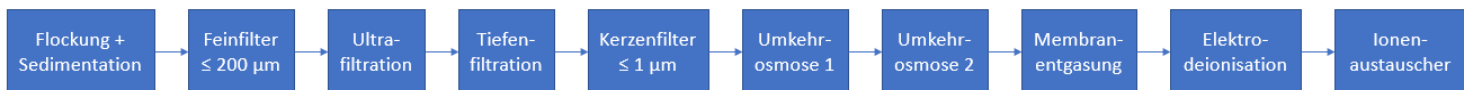
Abbildung 12 Verfahrenskette zur Aufbereitung von Oberflächenwasser am Beispiel des Ems-Jade-Kanals am Standort Westerende-Kirchloog
