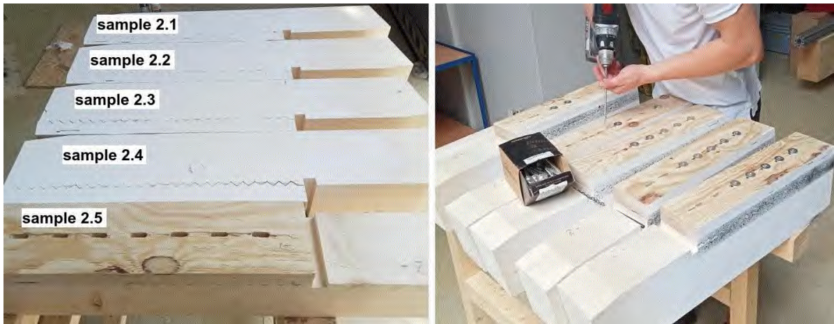
Bild 2.6: Einbringen von je fünf Holzschrauben Rothoblaas TBS MAX 8x120mm in die fünf Prüfkörper 2.1, 2.2, 2.3, 2.4 und 2.5 mit symmetrischen Zähnen.
