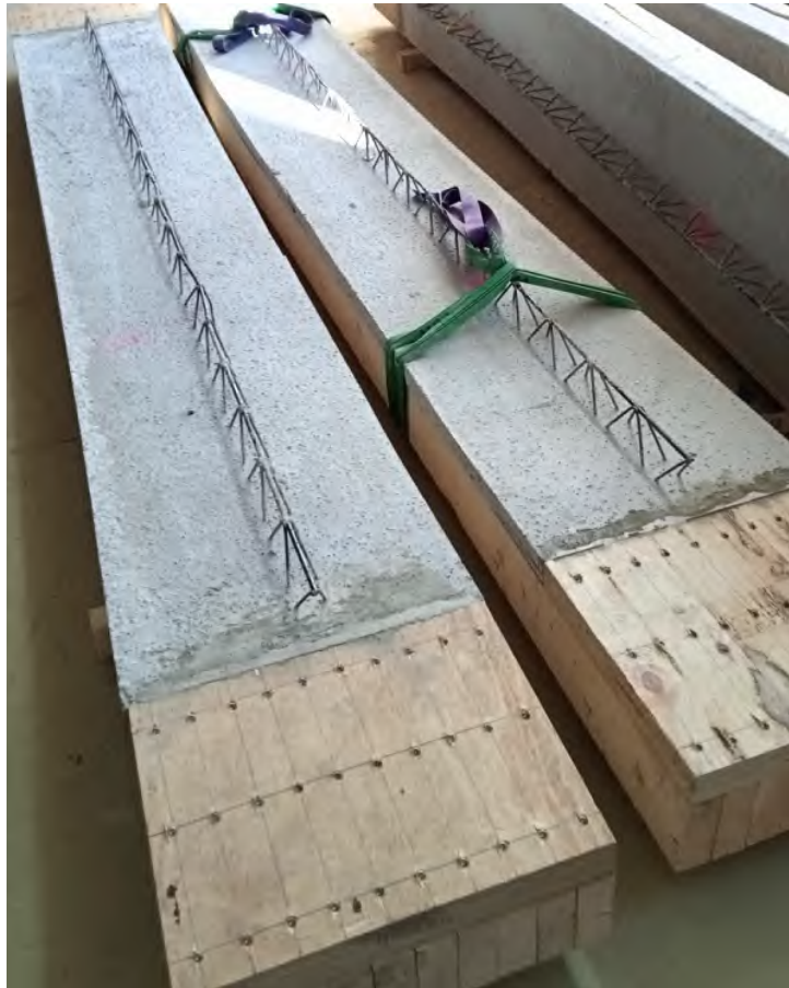
Bild 5.2: Von den beiden 220x600x5000mm Prüfdecken war eine verzahnt, die andere unverzahnt. Beide Decken waren mit sechs Schrauben pro Lamelle verschraubt (Tabelle 5.2, Seite 74).
