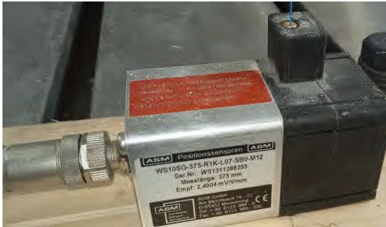
Bild 6.5: Mit drei identischen Seilzugpotentiometern von https://www.asm-sensor.com (zuletzt aufgerufen März 2025) wurde die Durchbiegung in der Mitte der vier geprüften Holz-Beton-Verbunddecken gemessen.
