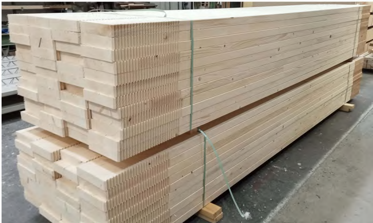
Bild 4.1: Oben: Die zwei 60 mm hohen Elementdecken aus C25/30 Beton, die als Druckgurt wirken, wurden von der Firma Stigloher in Bad Aibling gefertigt ( https://www.beton-stigloher.de , zuletzt aufgerufen Mai 2025). Unten: Die 88 Holzlamellen 60x5000x260mm mit auf einer Hundegger Abbundmaschine „K2-Industry 650“ eingefrästen, symmetrischen Zähnen an beiden Enden. Die Holzlamellen wirken als Zuggurt.
