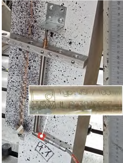
Bild 2.9: Zwei LVDT Wegsensoren von HDM (Hottinger-Brüel & Kjaer https://www.hbm.com/ , zuletzt aufgerufen Mai 2025) sind bei allen 10 Prüfkörpern auf dem Mehrschichtfurnierholz angebracht - je einer auf der linken Seite und einer auf der rechten Seite (rechte Seite hier nicht sichtbar).
