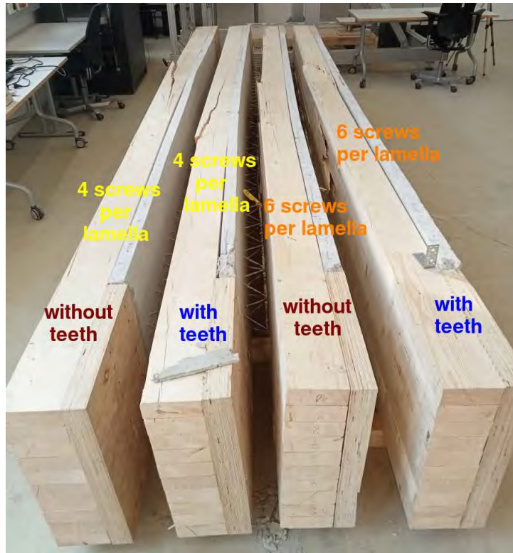
Bild 6.19: Die vier streifenförmigen Holz-Beton-Verbunddecken mit dem Maßen 600x5000x220mm die in 4-Punktbiegetests bis zum Bruch belastet wurden. Bruchkräfte zusammengefasst in Tabelle 6.1, Seite 87.
