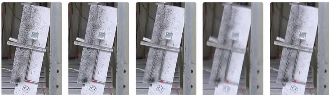
Bild 2.13: Sequenz von fünf aufeinanderfolgenden Videobildern im Abstand von 0.02 Sekunden ( \frac{1}{50}s ), aufgenommen mit einer Sony Kamera mit 50 Bildern pro Sekunde, als die asymmetrischen Zähne von Probekörperpaar 1.5 abbrechen. Die Zähne brechen schlagartig mit lautem Knall am Zahngrund ab. Der Zahnbruch erschüttert die Presse und deshalb ist das 4te Bild von links verschwommen.
