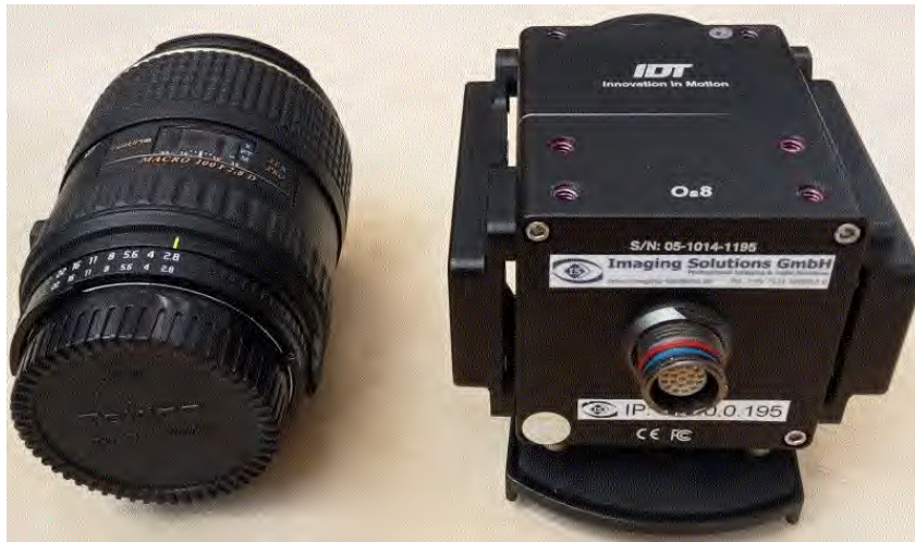
Bild 3.7: Rechts: Hochgeschwindigkeitskamera „IDT os8-S3“ ( https://idtcameras.com , zuletzt aufgerufen Mai 2025) mit 1600x1200 pixel (2 Megapixel) kann bis zu 8000 fps (frames per second) aufnehmen. Links: Als Objektiv diente ein „Tokina Macro 100 F2.8D“.
