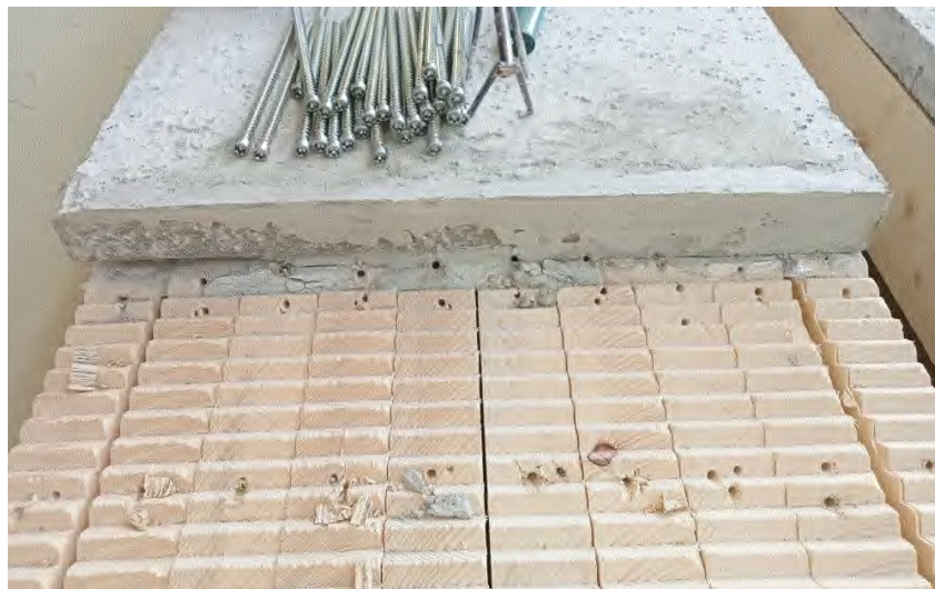
Bild 6.17: Die 600x5000x220mm Holz-Beton-Verbunddecke mit sechs Schrauben pro Lamelle nach dem Biegebruch im 4-Punktbiegetest nach dem Abschrauben der Schubknagge. Sowohl die Lamellenzähne als auch die Knaggenzähne sind völlig intakt. Der schwundlose Mörtel floß auf der linken Seite nicht komplett in den 5mm-Spalt. Mörtelfuge identisch mit der in Bild 6.16 rechts unten.
