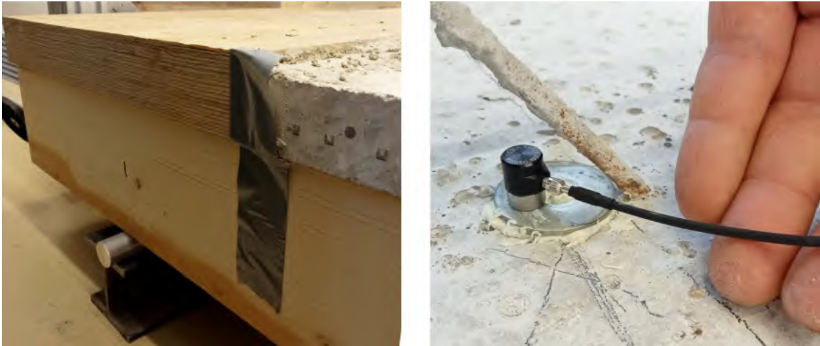
Bild 5.4: Links: Aluminiumroller als Auflager auf einem I-Träger. Rechts: Angeklebte Beilagscheibe für die magnetische Aufnahme des Beschleunigungssensors in der Mitte der Prüfdecke.
