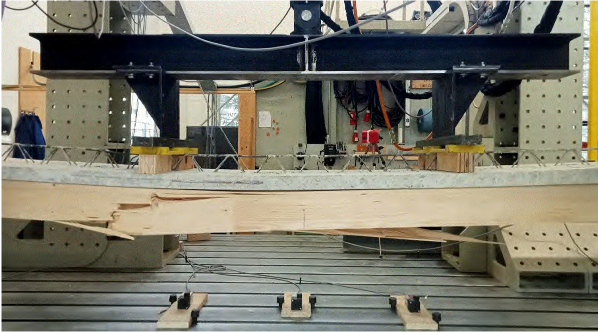
Bild 6.14: Alle vier getesteten 600x5000x220mm Holz-Beton-Verbunddecken im 4-Punktbiegetest versagten durch Biegebruch. Alle Schubknaggen aus Mehrschichtfurnierholz blieben dagegen unversehrt. Ein Video eines der vier Biegetests ist auf https://youtu.be/T0mGDKxsgi4 (zuletzt aufgerufen Mai 2025).
