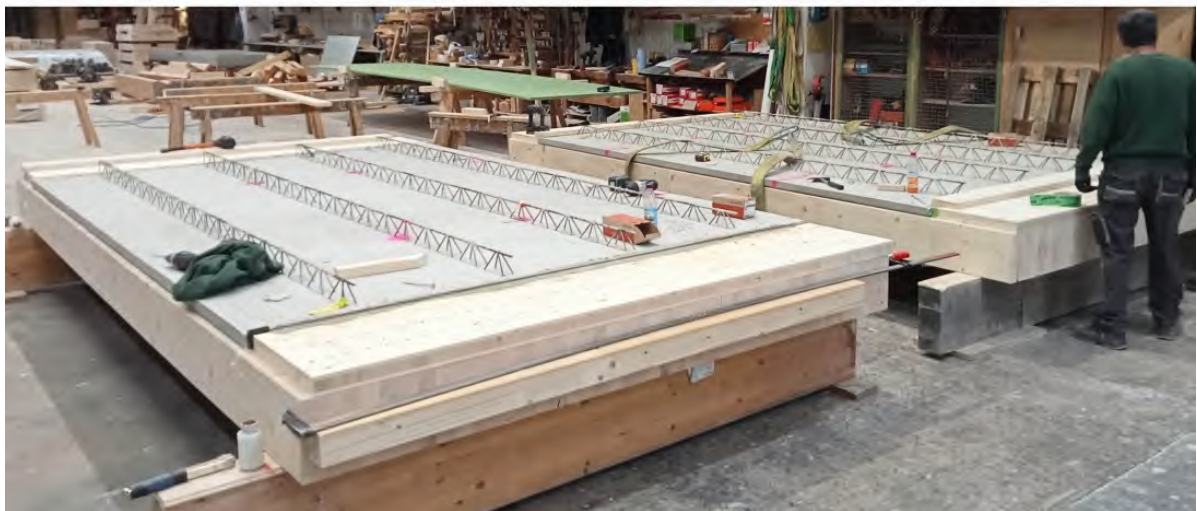
Bild 4.3: Oben: Einheben einer Elementdecke aus Beton mit dem Hallenkran beim Projektpartner https://www.huber-sohn.de (zuletzt aufgerufen April 2025). Unten: Die beiden gefertigten Deckenelemente nebeneinander. Die Nut-und-Feder Verbindung ist am linken Deckenelement erkennbar.
