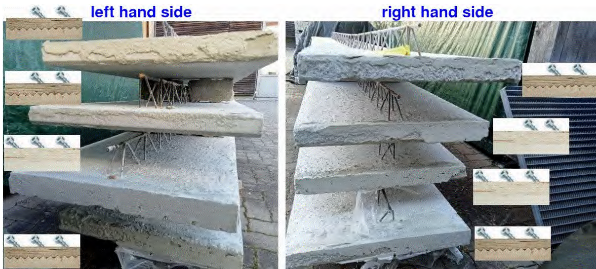
Bild 6.16: Ausbau der Betondecken nach den Biegetests. Die Mörtelfuge war in drei von vier Holz-Beton-Verbunddecken nicht komplett befüllt und wies Hohlräume auf. Die unverzahnte Decke mit sechs Schrauben pro Lamelle (dritte Decke von oben) war als einzige vollständig befüllt. Dies erklärt die höchste Steifigkeit dieser Decke.
