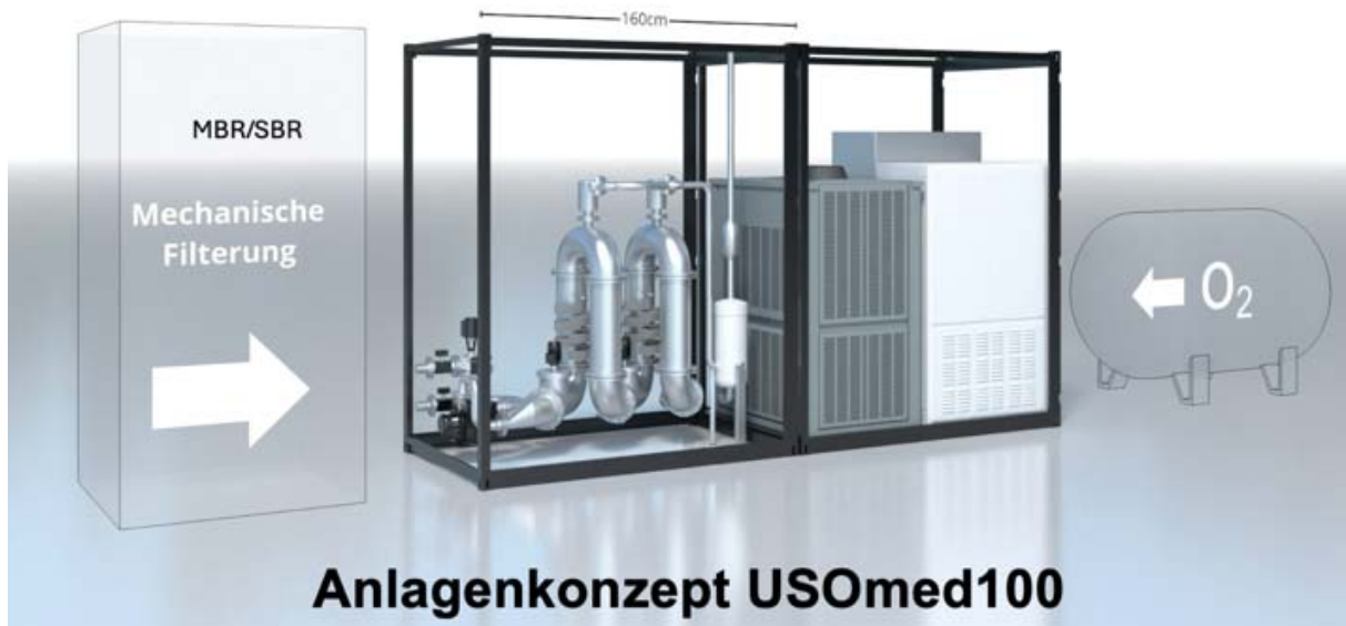
Abbildung 1 Anhang 3: Anlagenkonzept für eine mögliche Umsetzung der USONiQ-Ozonung für ein Krankenhaus mit einer Kapazität von 100 Betten.
