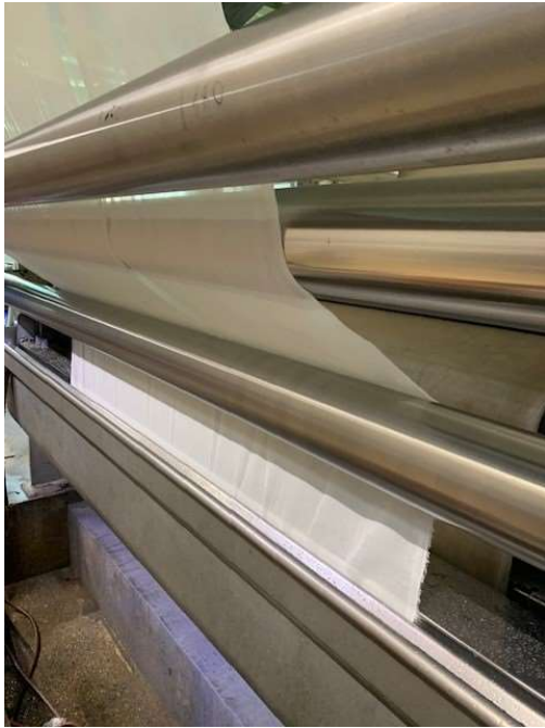
Abb. 9 und 10: Ausrüstungsversuche in der Firma Pfand, links: Wareneinlauf im Chemikalienfoulard rechts: vor den Heizfeldern
