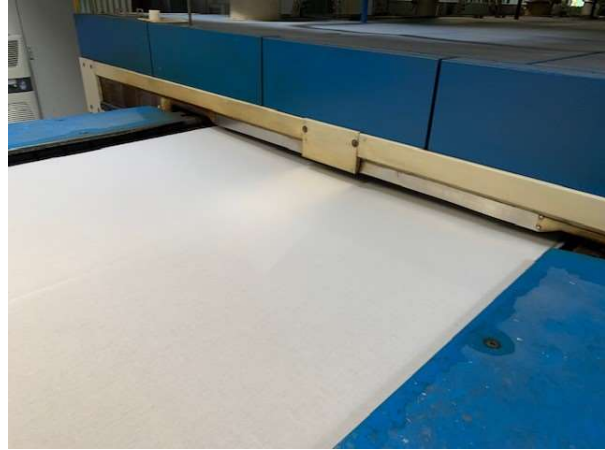
Abb. 9 und 10: Ausrüstungsversuche in der Firma Pfand, links: Wareneinlauf im Chemikalienfoulard rechts: vor den Heizfeldern
