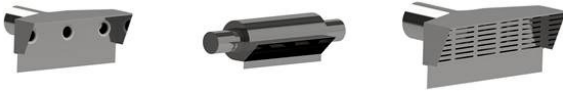
Abbildung 14: Beispiele untersuchter Varianten der Erfassungshauben (v.l.: Düsenplatte, Wirbelhaube, Schlitze)
