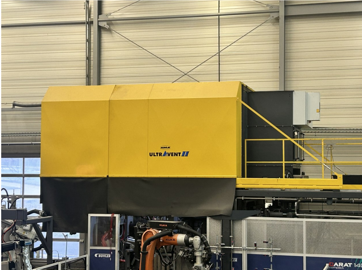
Abbildung 2: Raucherfassungshaube über Kaltkammerdruckgießzelle am Fachgebiet für Gießereitechnik der Universität Kassel
