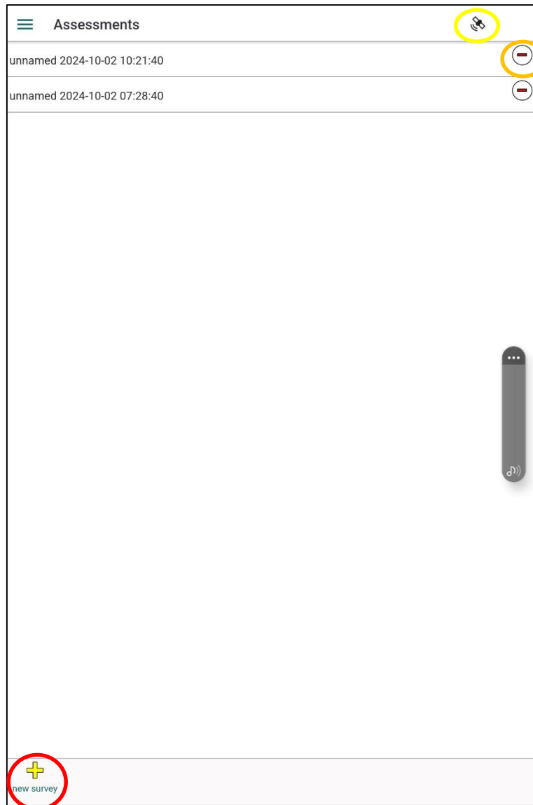
Abbildung 3: Funktion „Kartierungen“ („Assessments“), zu der man aus dem Hauptmenü über die Option „Survey“ gelangt. Rote Markierung: Button zum Anlegen einer neuen Kartierung. Orangene Markierung: Button zum Löschen einer Kartierung. Gelbe Markierung: Anzeige, dass GPS-Empfang besteht.
