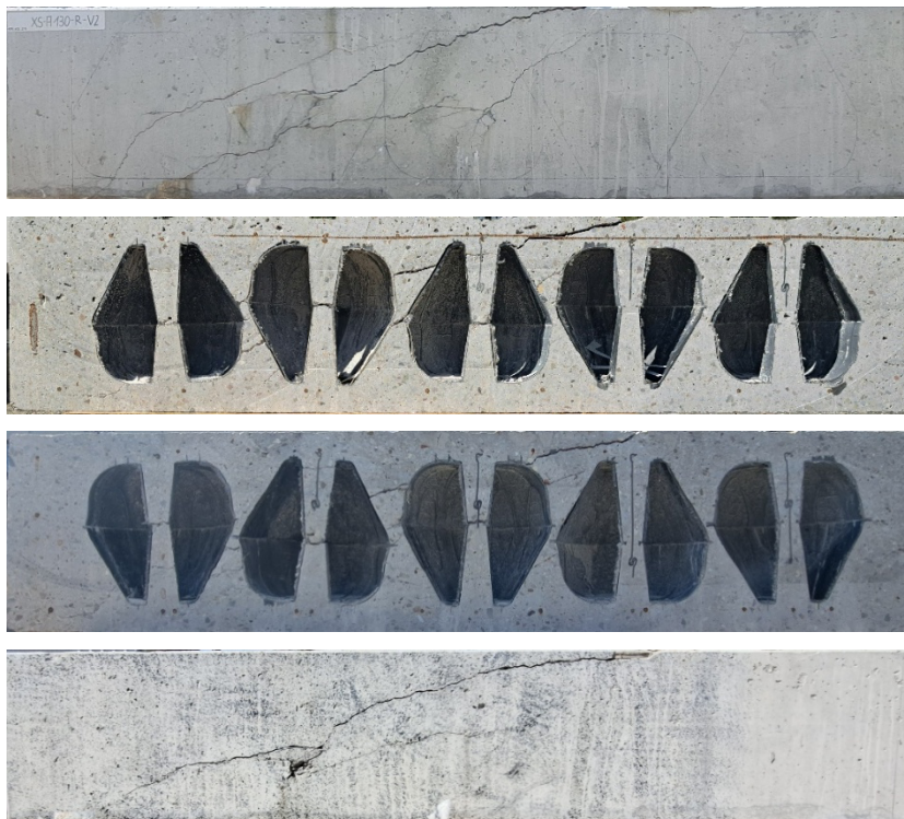
Abbildung 30: Rissverlauf an Außenseiten & an Schnittflächen XS-A 130 R – V2
