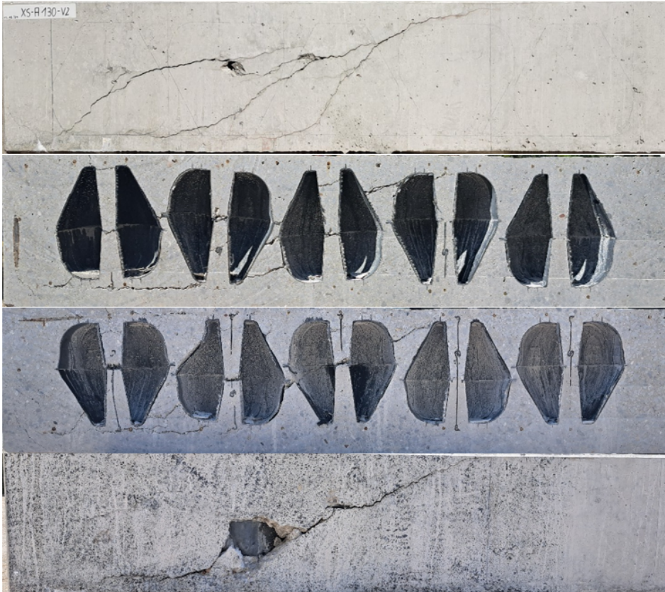
Abbildung 28: Rissverlauf an Außenflächen sowie an Schnittflächen, XS-A 130 V2
