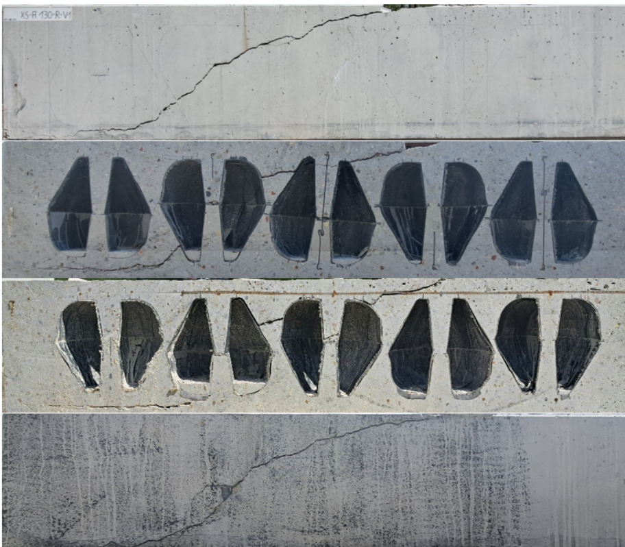
Abbildung 29: Rissverlauf an Außenflächen sowie an Schnittflächen, XS-A 130 R V1
