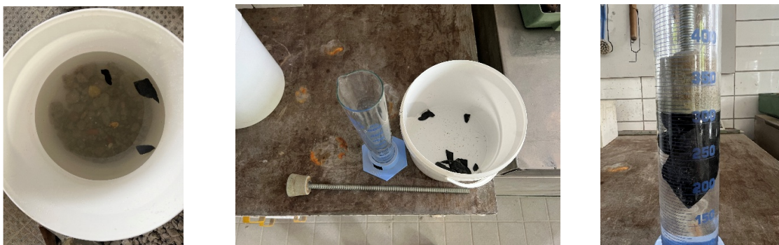
Abbildung 35: Separation der schwimmenden Kunststoffteile von der Messprobe (links) und Ermittlung des Volumens mittels Messzylinder und Tauchkolben.
