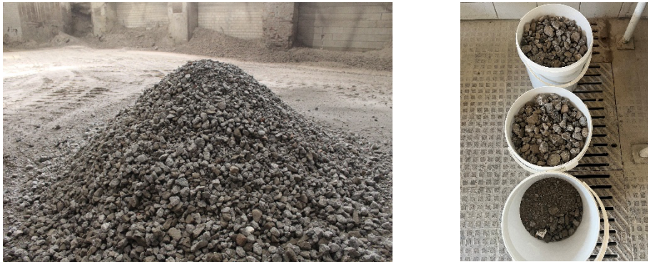
Abbildung 34: Hergestellte rezyklierte Gesteinskörnung des Korngemischs 0/45 (links) und entnommene Proben zur weiteren Untersuchung (rechts)
