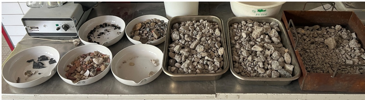
Abbildung 36: Getrocknete und sortierte Bestandteile der Messprobe
