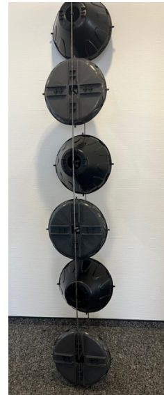
Abbildung 19: Abmusterung der XS-A Halbschalen und Testmontage mit den XS-H Halbschalen zu Hohlkörpern XS-A
