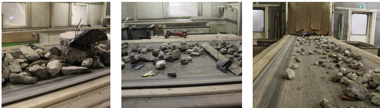
Abbildung 33: Reduktion der Kunststoffanteile bei drei aufeinander folgenden Durchgängen durch den Aufbereitungsprozess der Brechanlage
