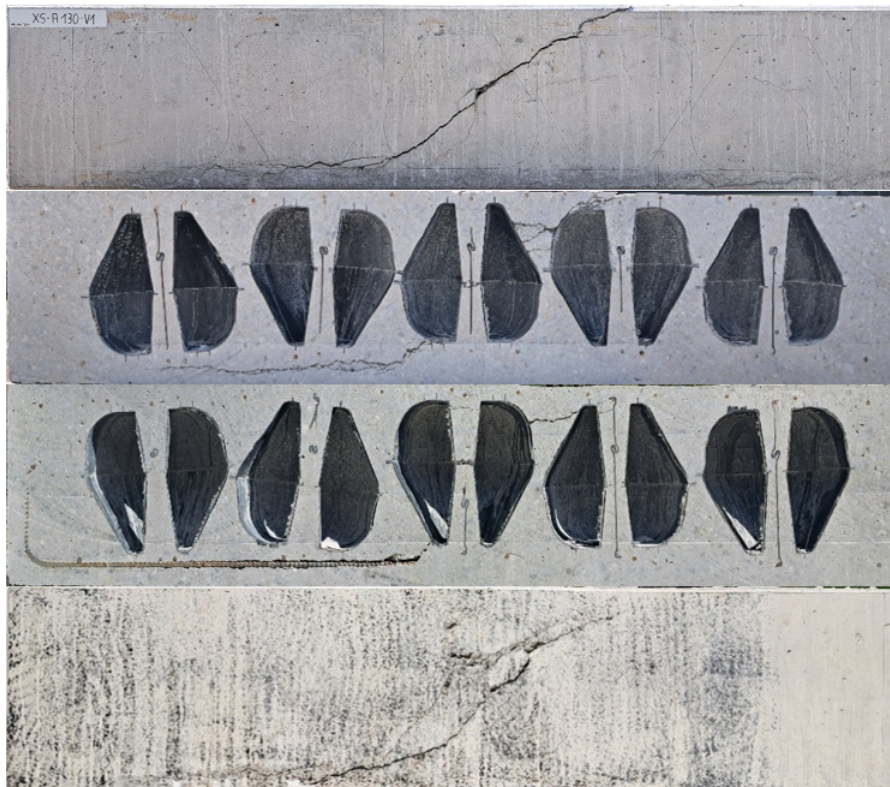
Abbildung 27: Rissverlauf an Außenflächen sowie an Schnittflächen, XS-A 130 V1
