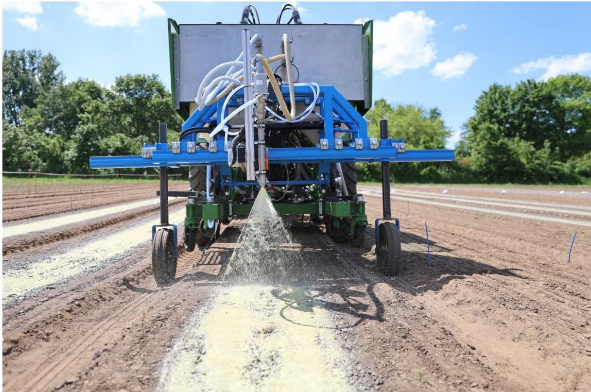
Abbildung 57: Spritzbild bei der Applikation der 60 cm breiten Mulchstreifen mit dem MulchSprayer Vegi im Versuchsjahr 2024
