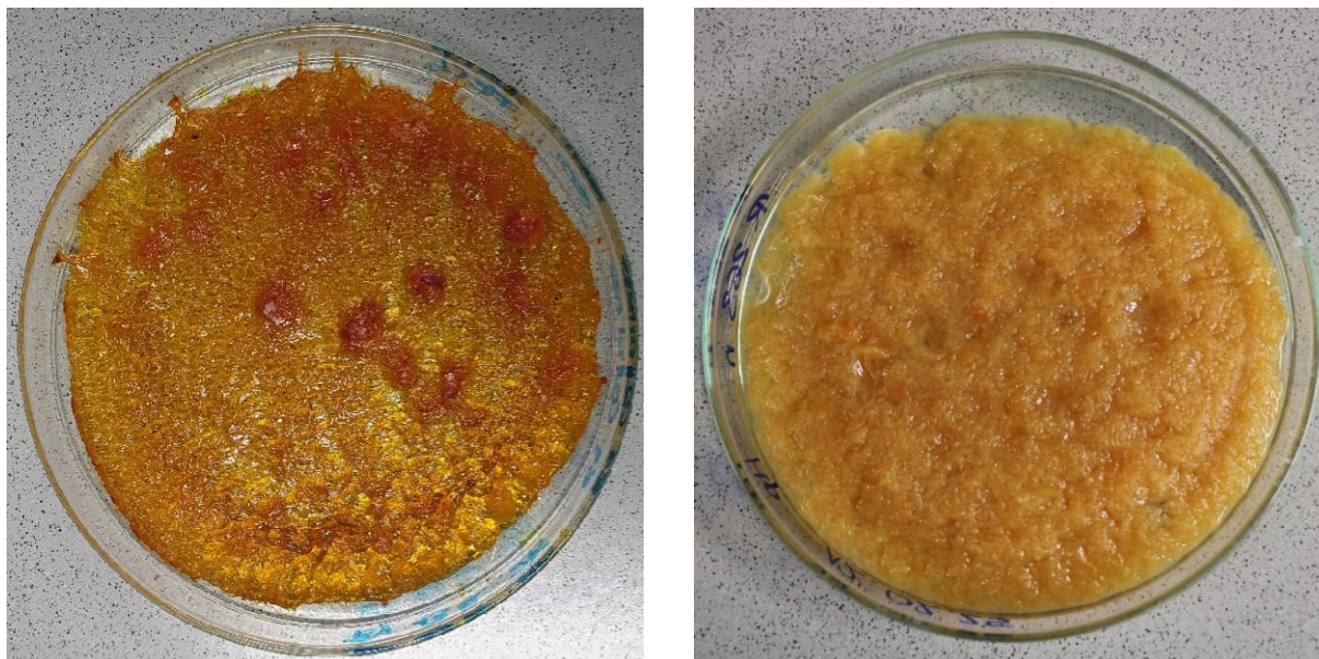
Abbildung 17: Prüfkörper der ölfreien Rezepturen mit Carboxymethylcellulose und Gelierverzögerer R 264g (links) mit Glucono- \delta -lacton und R 263n (rechts) mit Natriumphosphat
