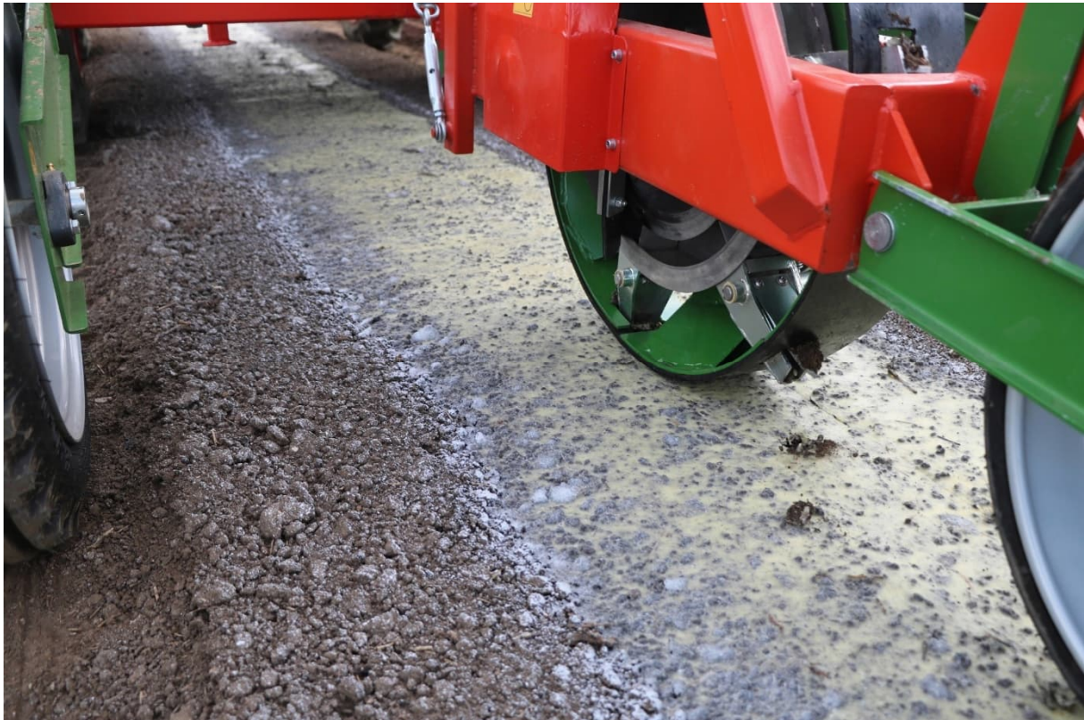
Abbildung 7: Aussaat der Einlegegurkensamen in das Mulchmaterial am 07.05.2025 mit Hilfe eines pneumatischen Sägeräts der Firma Fleischmann
