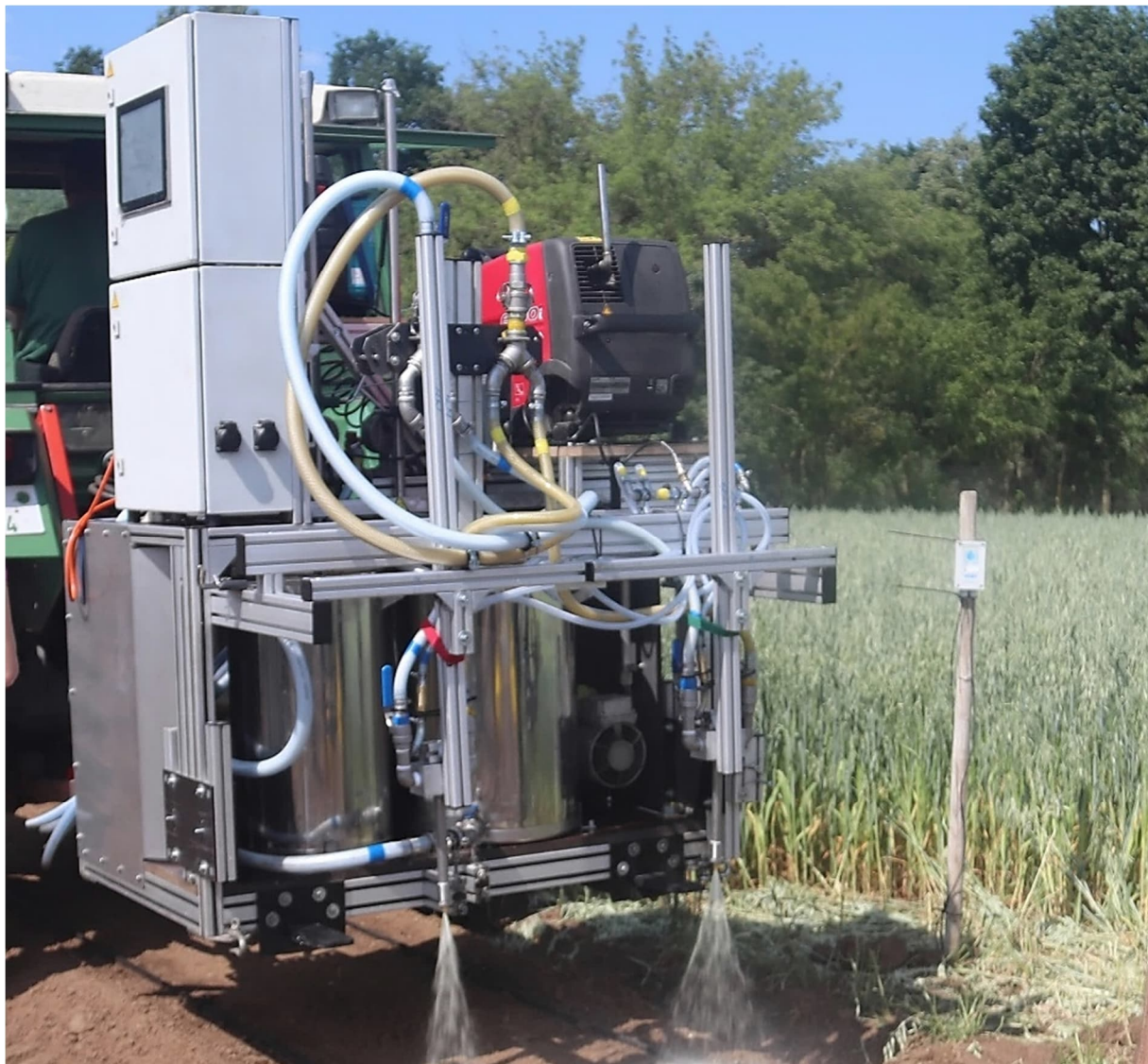
Abbildung 4: Das Applikationsgerät SAM in der Rückansicht während der Applikation des Mulchmaterials in der Reihenkultur Zuckermais
