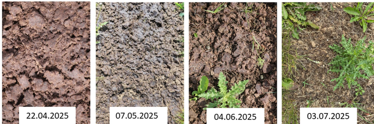
Abbildung 21: Witterungsbeständigkeit und Beikrautunterdrückung des Materials Rezeptur 208b mit einer Schichtdicke von 5 mm über die Zeit von April bis Juli 2025
