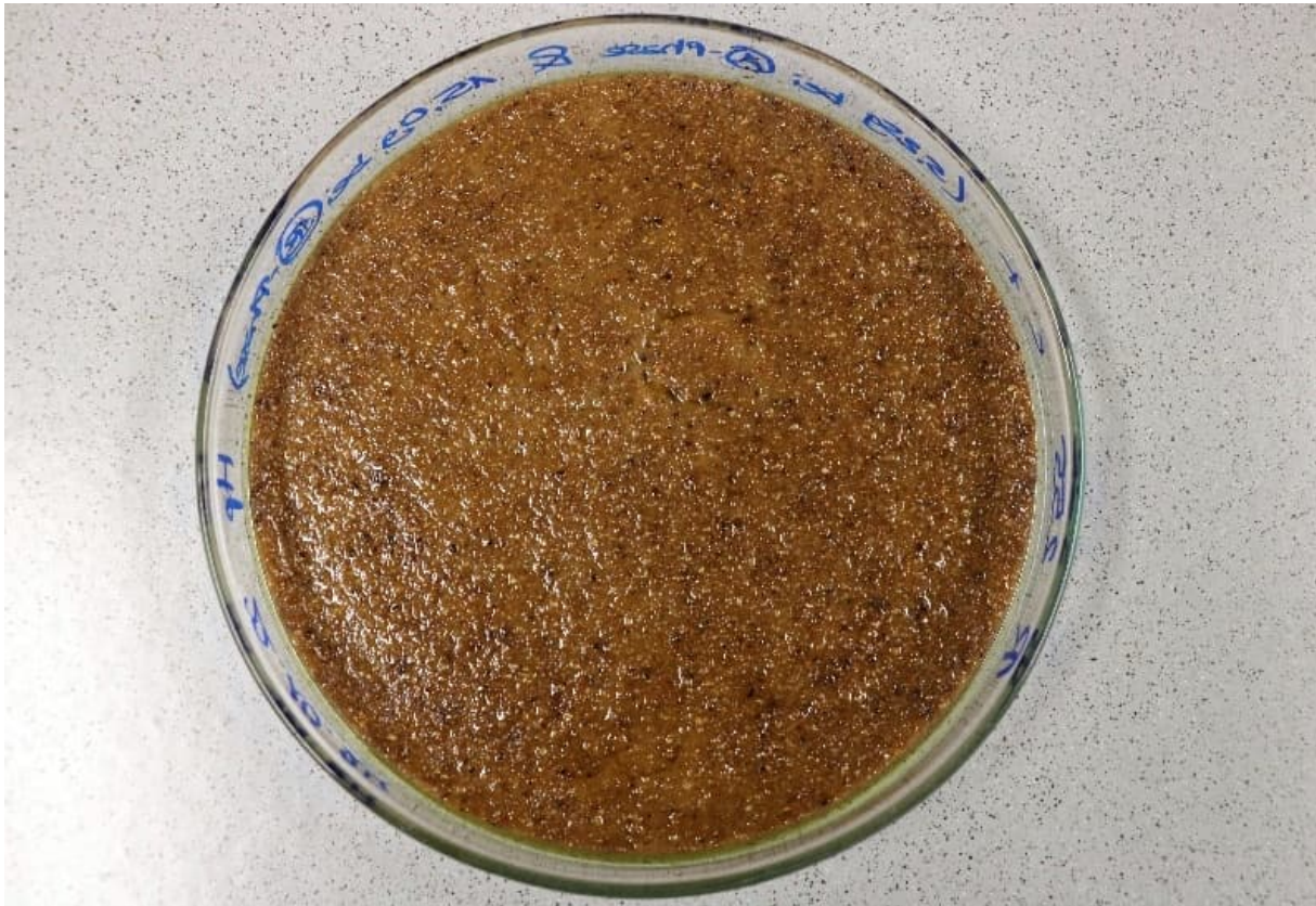
Abbildung 18: Prüfkörper der modifizierten Rezeptur R 114k mit Apfeltrester als Füllstoffersatz (R 255c+)
