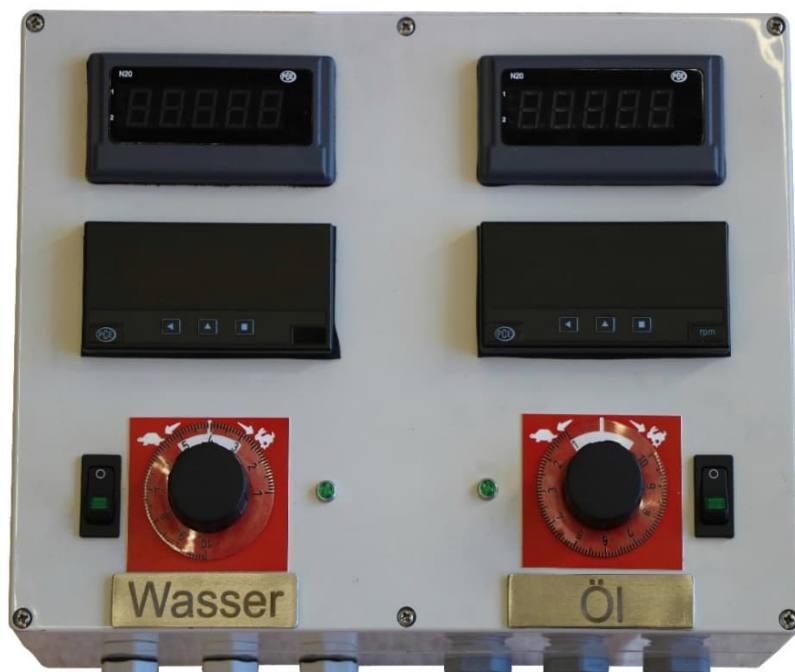
Abbildung 54: Bedienterminal des Applikationsgeräts zum Einbau in der Fahrerkabine
