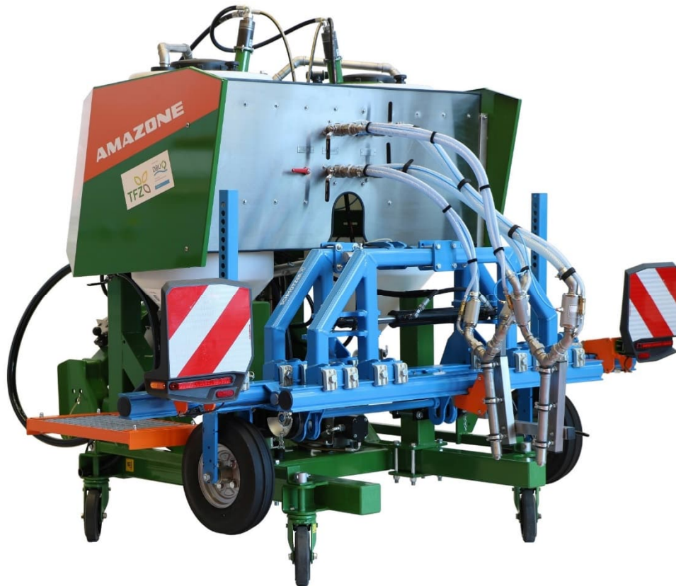
Abbildung 56: Prototyp II MulchSprayer Vegi nach Umbau- und Optimierungsmaßnahmen in der Heckansicht - Stand 2025
