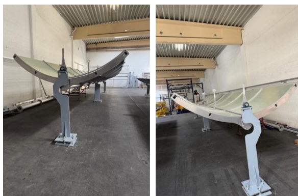
Abbildung 5: Aufstellung des Kollektorstranges nach der Lieferung
