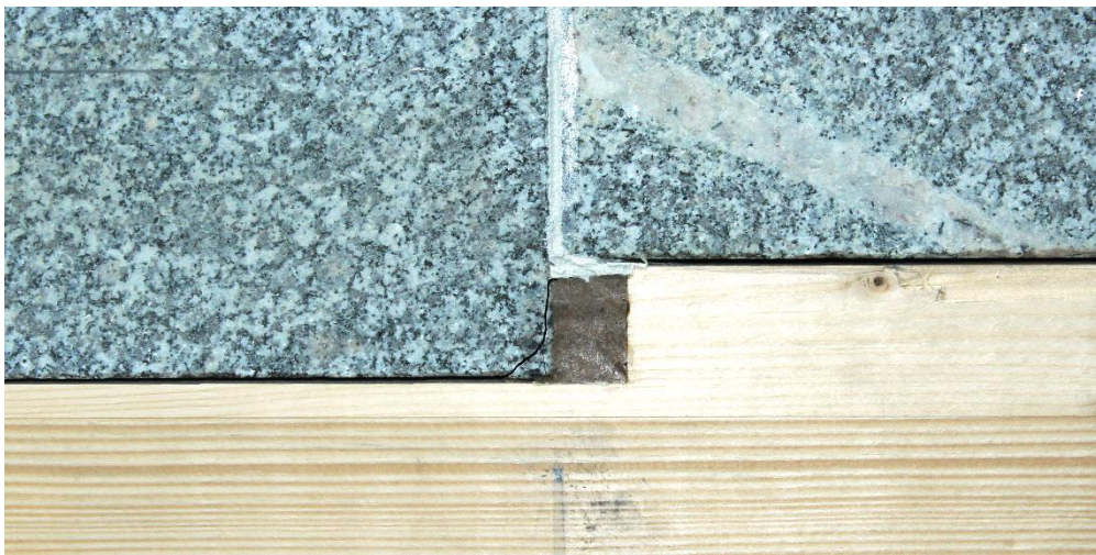
Abbildung 35: Rissbild der Vergussfuge aus Polymerbeton beim Probekörper HGB-POT-03 (Riss wurde zur besseren Sichtbarkeit nachgezeichnet)
