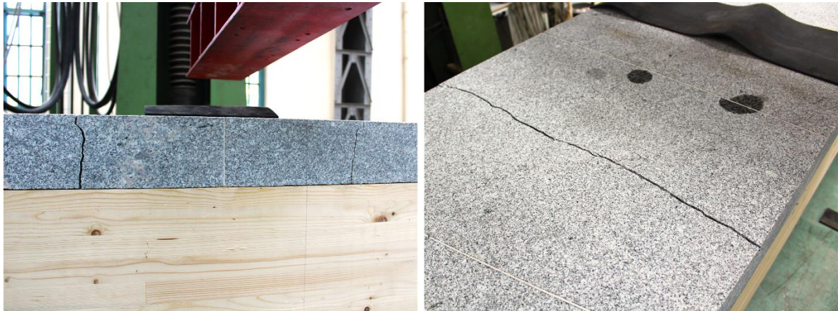
Abbildung 71: Seitenansicht (links) und Draufsicht (rechts) der gerissenen Granitplatte von Probekörper HGB-4PB2K nach Abbruch des Versuchs
