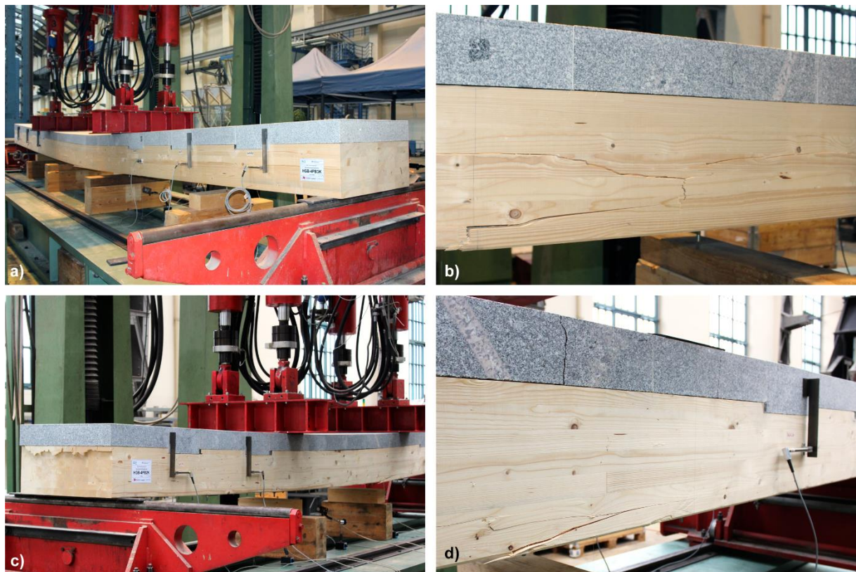
Abbildung 70: a),b): Probekörper HGB-4PB3K nach dem Biegeversagen des Brettschichtholzträgers c),d): Probekörper HGB-4PB2K nach dem Biegeversagen des Brettschichtholzträgers
