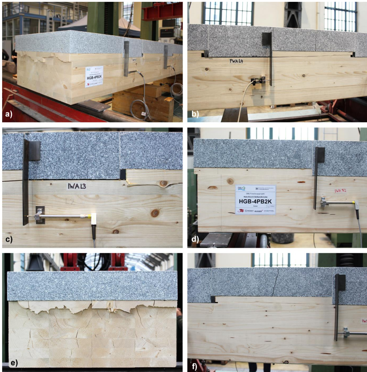
Abbildung 69: a),b),c): Bruchbilder des Kervenversagens bei Probekörper HGB-4PB3K d),e),f): Bruchbilder des Kervenversagens bei Probekörper HGB-4PB2K
