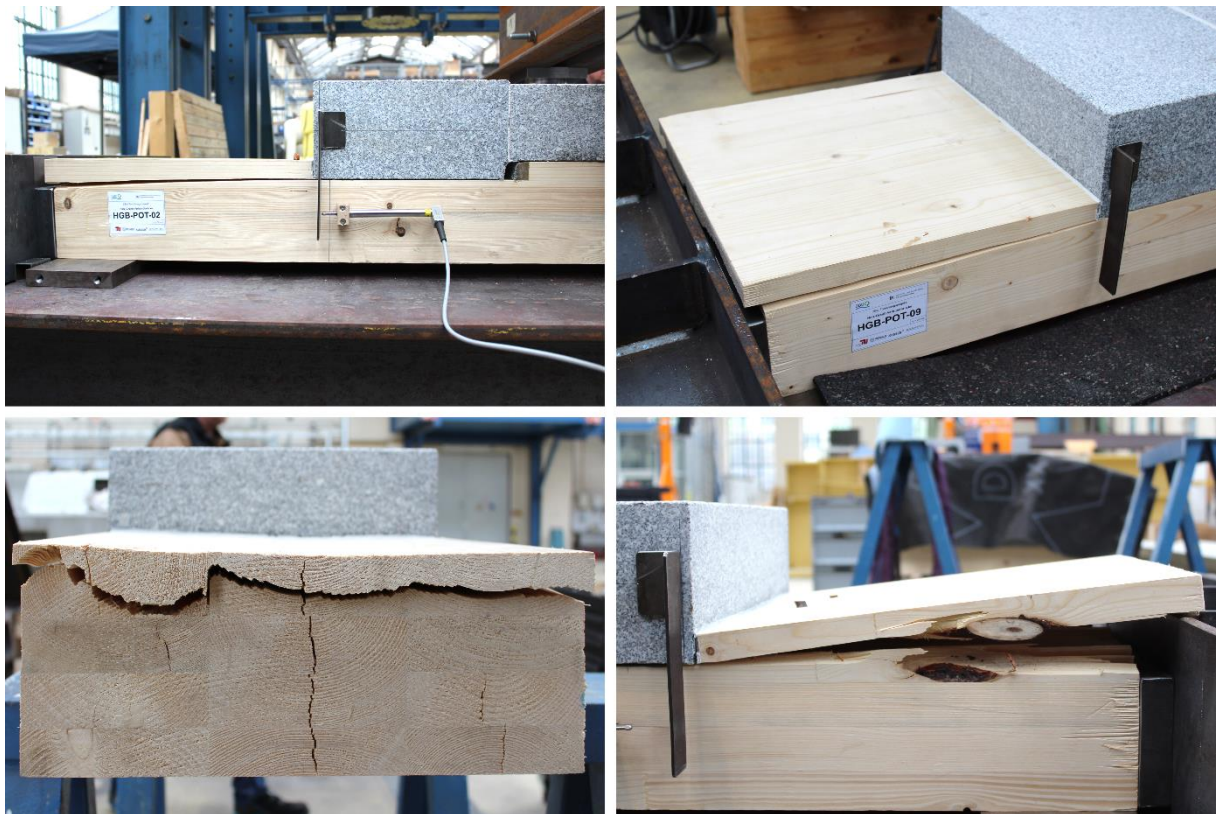
Abbildung 36: Bruchbild der Push-Off-Versuchskörper HGB-POT-02, -08, -09 und -10 nach ihrem Versagen durch Vorholzabscheren
