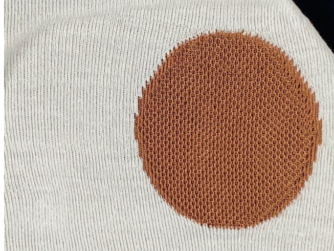
Abbildung 5 - Nahaufnahme des bereits im Strickprozess integrierten Lautsprecher-Musterfeldes
