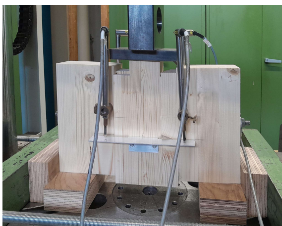
Abbildung 43: Versuchsaufbau der Druckscherversuche mit Doppel-Konusverbindern, Zustand nach dem Bruch Prf.-1
