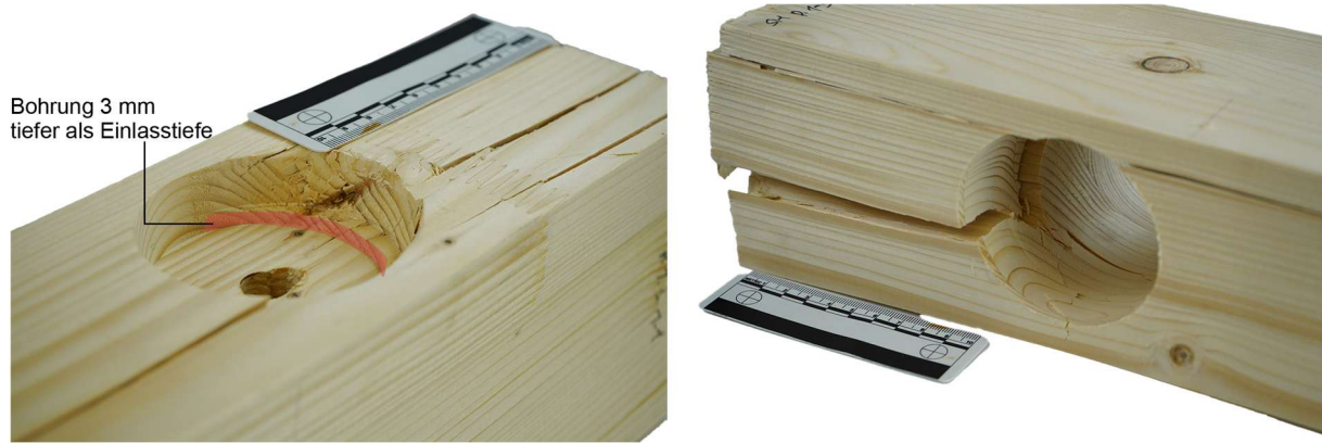
Abbildung 50: Versagen im MH (links) und SH (rechts)
