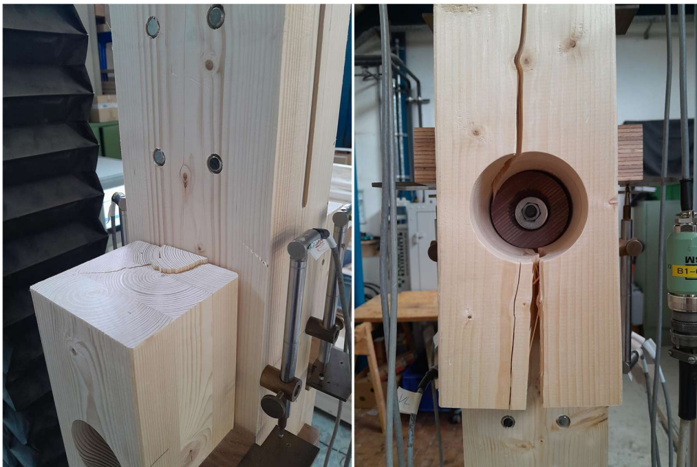
Abbildung 52: Versagensverhalten in Zugscherversuchen mit Konusadaptern
