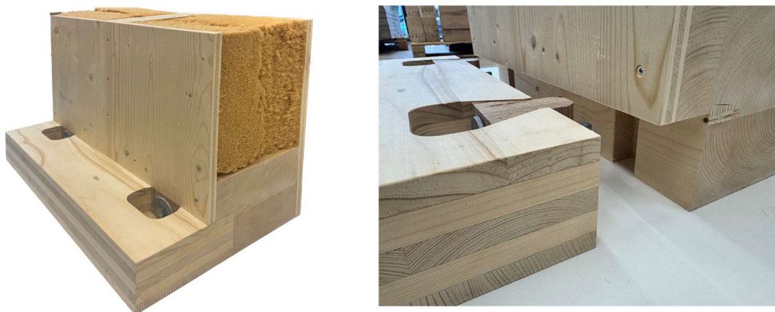
Abbildung 10: Mock-Up mit Anwendung der Variante mit Schubverbinder
