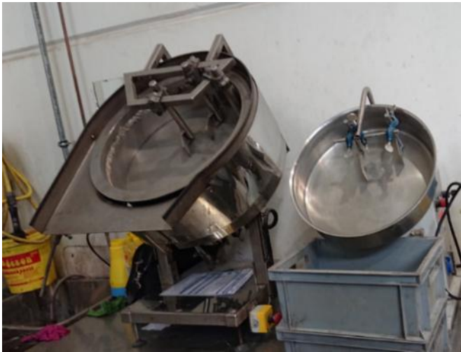
Abbildung 17: Pelletierteller mit Durchmesser 50 cm (links) und 40 cm (recht)
