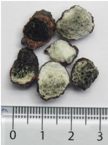
Abbildung 27: Glasschaum nach Einsatz als Abdeckung auf einer Kupferschmelze
