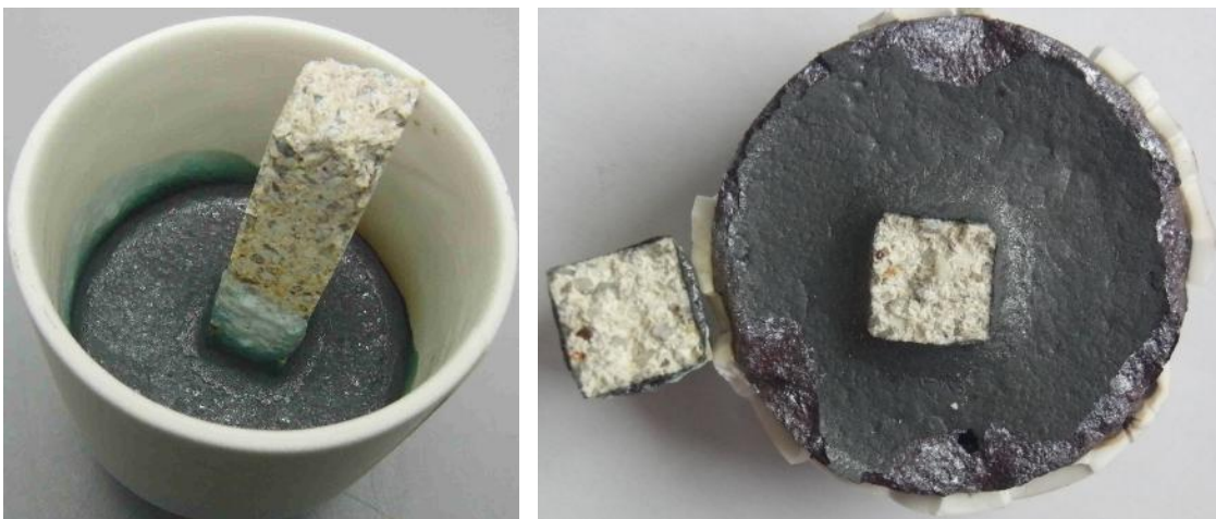
Abbildung 16: Fingertest Mullit-Stampfmasse/Quarzglasmehl zur Korrosionsuntersuchung
