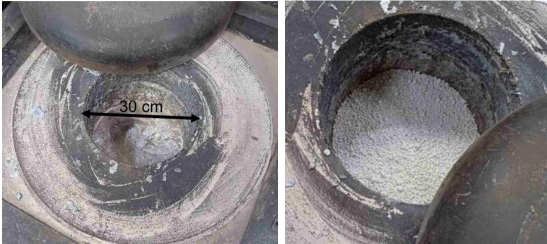
Abbildung 20: Industrierversuch AC Tech GmbH - links Induktionsofen mit Schmelze, rechts Grünkorn auf Schmelze
