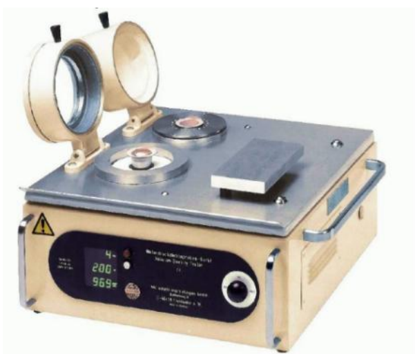
Abbildung 21: Messgerät zur Unterdruckdichtepprüfung [11]
