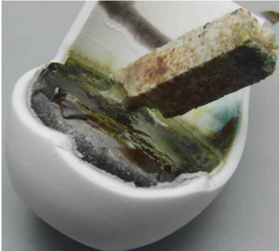
Abbildung 14: Fingertest Mullit-Stampfmasse/Filterstaub zur Korrosionsuntersuchung
