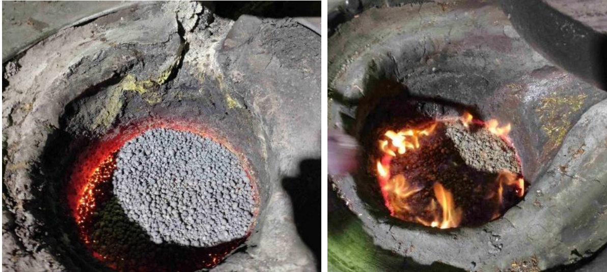
Abbildung 26: Grünkorn nach Aufgabe auf eine Kupferschmelze (links); reduzierende Wirkung (rechts)
