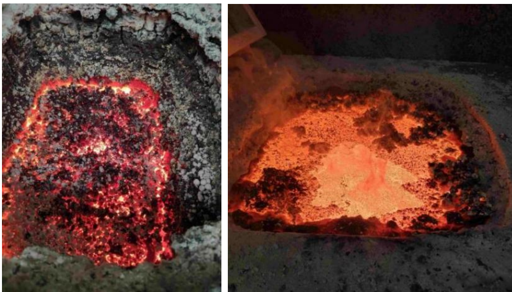
Abbildung 29: Warmhalteofen der Stranggussanlage; links mit Abdeckung, rechts nach Abschlagen
