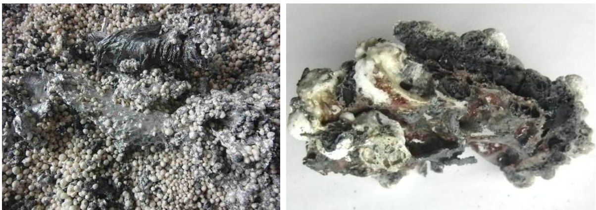
Abbildung 34: Glasschaum mit Schmelzeanhaftungen nach Industrieversuchen (links Al, rechts Cu)
