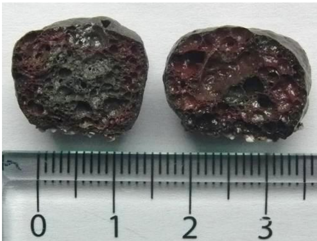
Abbildung 35: Laborergebnis zum Recycling: Foto des Querschnitts eines Schaumglasgranulates aus recycelten Rohstoffen
