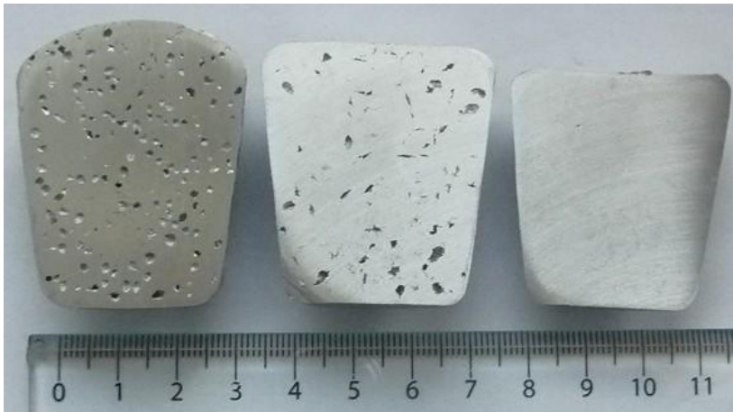
Abbildung 25: Probenschliffe nach Unterdruckdichtemessung: von links – vor Abdeckung, nach 2 h Abdeckung, nach 7 h Abdeckung
