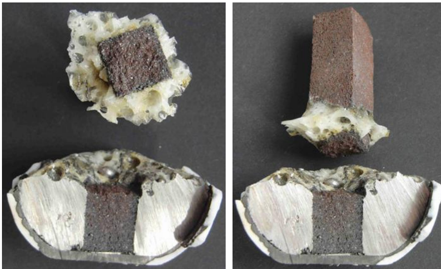
Abbildung 13: Fingertest SiC (Aluminiumschmelze) zur Korrosionsuntersuchung
