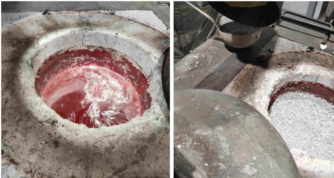
Abbildung 23: Widerstands-Tiegelofen mit Aluminiumschmelze & Schaumglasabdeckung
