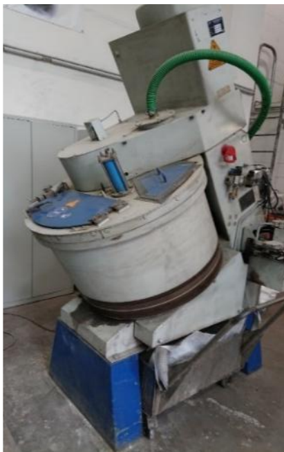
Abbildung 18: Mischer für 90 kg Batches & Pelletierteller Durchmesser 100 cm
