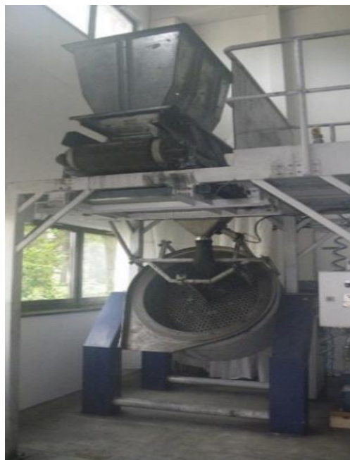
Abbildung 18: Mischer für 90 kg Batches & Pelletierteller Durchmesser 100 cm
