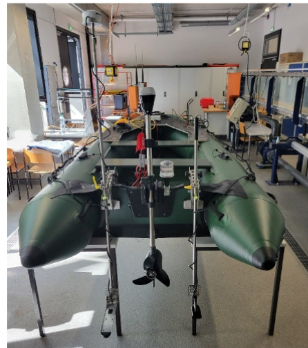
Abbildung 2: Beispielhafte Montage eines Echolots (Quelle: eigene Darstellung)
