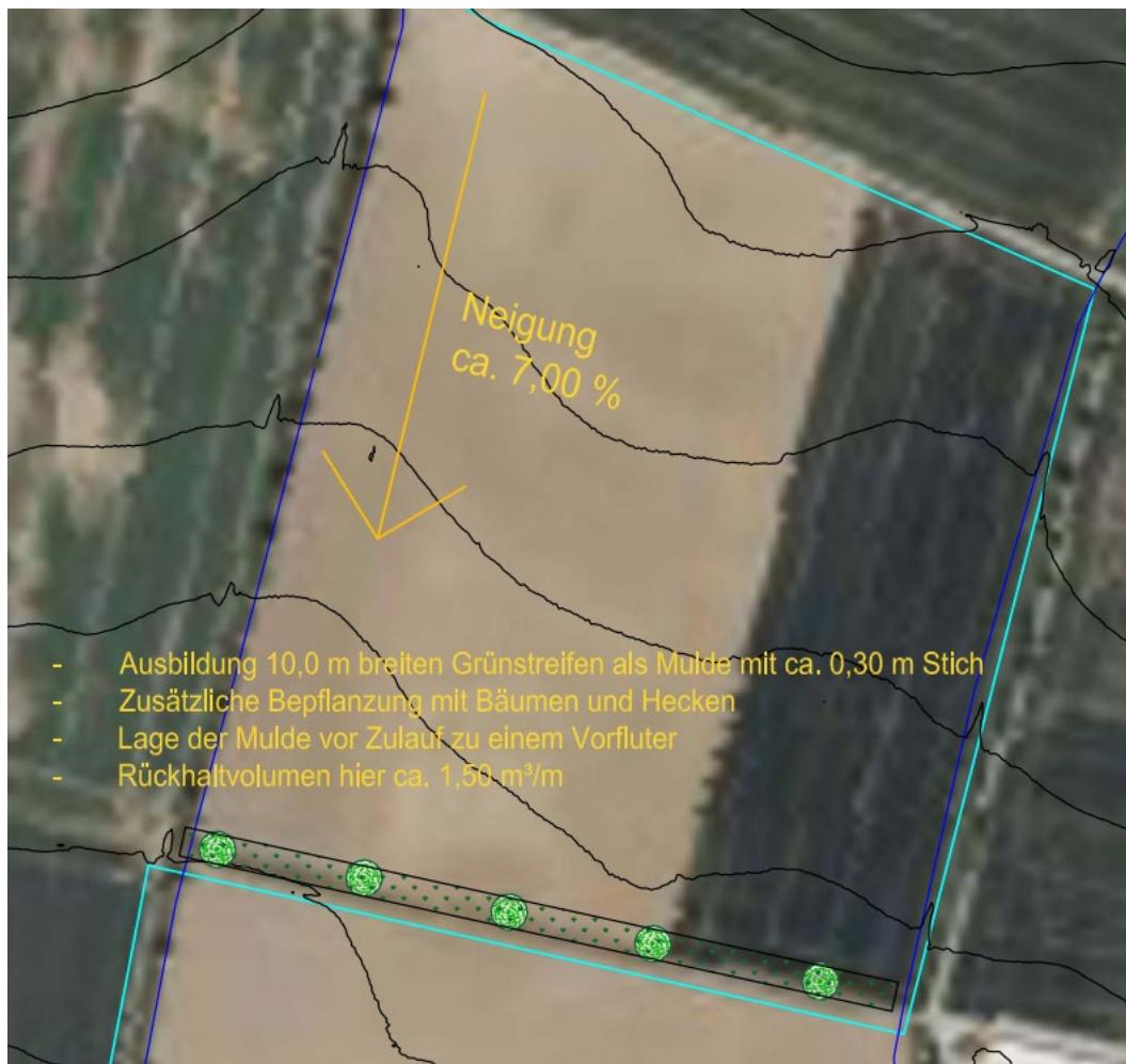
Abbildung 73: Draufsicht dezentraler Rückhalt Goldbergsee (Quelle: eigene Darstellung)
