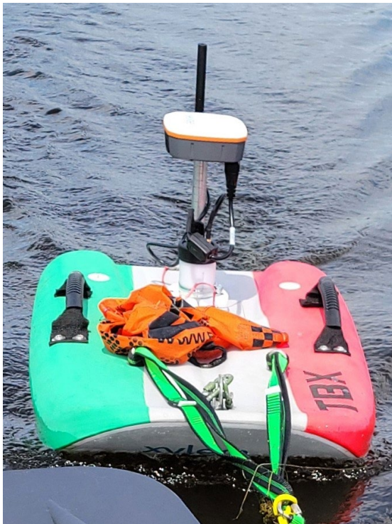
Abbildung 29: ADCP (Quelle: eigene Darstellung)
