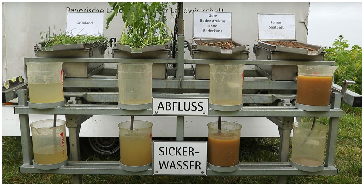
Abbildung 58: Videoausschnitt des Regensimulators des LfL (Quelle: https://youtu.be/PzjiubMdygY , Minute 3:23, aufgerufen 05.05.2025)
