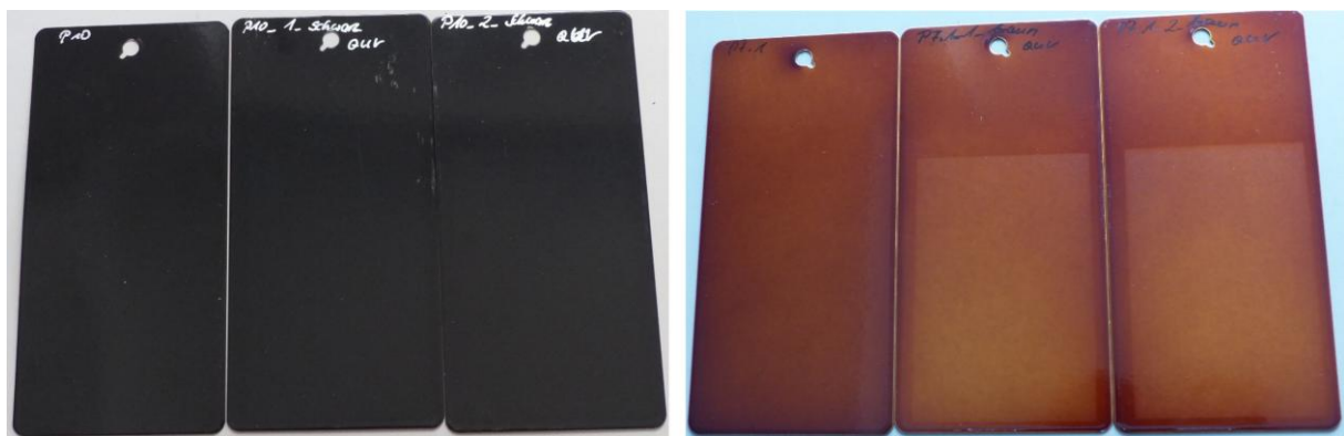
Abb. 24: Visueller Zustand nach UV-A-Belastung; links nach 300 h ohne visuelle Veränderung, rechts nach 100 h mit starker visuell wahrnehmbarer Veränderung
