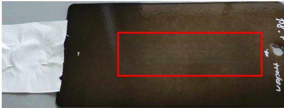
Abb. 25: Visueller Zustand nach Crockmeterprüfung mit 100 Doppelhüben; trocken
