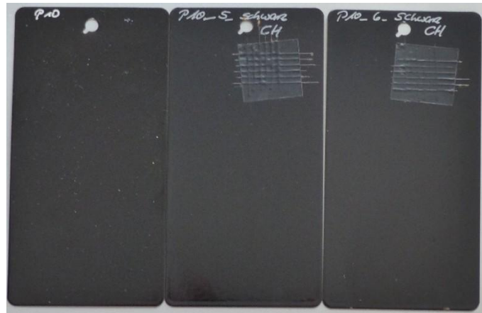
Abb. 22: Bewertung nach 480 h Kondenswasserkonstantklima zu einem unbelasteten Vergleichsstandard (links)
