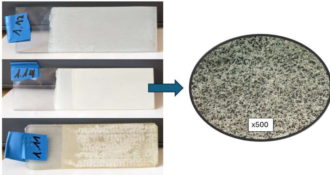
Abbildung 7: Fotografie hergestellter Katalysator-Teststück und Mikroskopie des Katalysator-Materials
