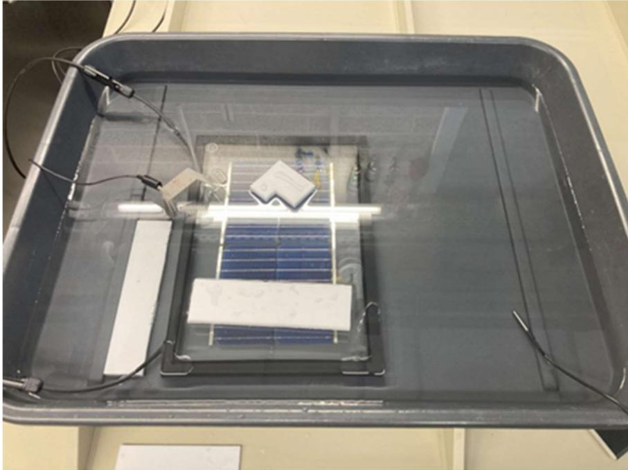
Abbildung 29: Nasstest für Isolationsprüfung, Bild: ISFH, Dr. Kevin Meyer
