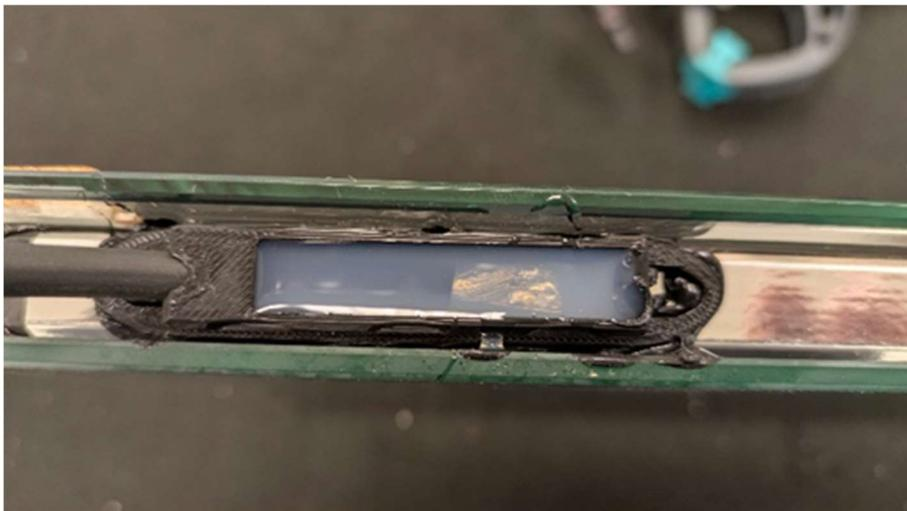
Abbildung 10: Anschlussbox/Junctionbox mit Vergussmasse verfüllt
