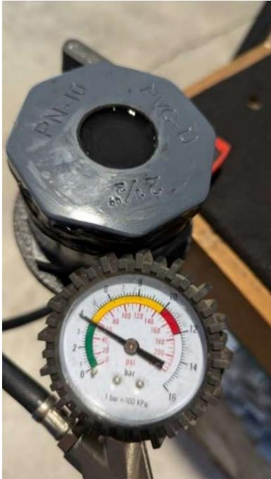
Abbildung 21: Dichtigkeitsstest von 3D
