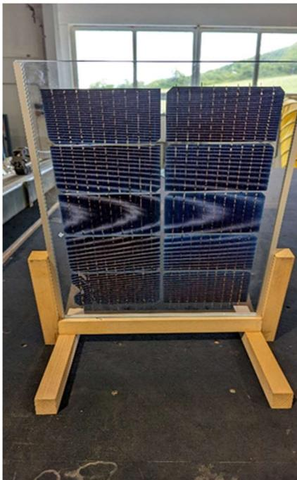
*Abbildung 31: Testmuster für Ablöseversuche*
