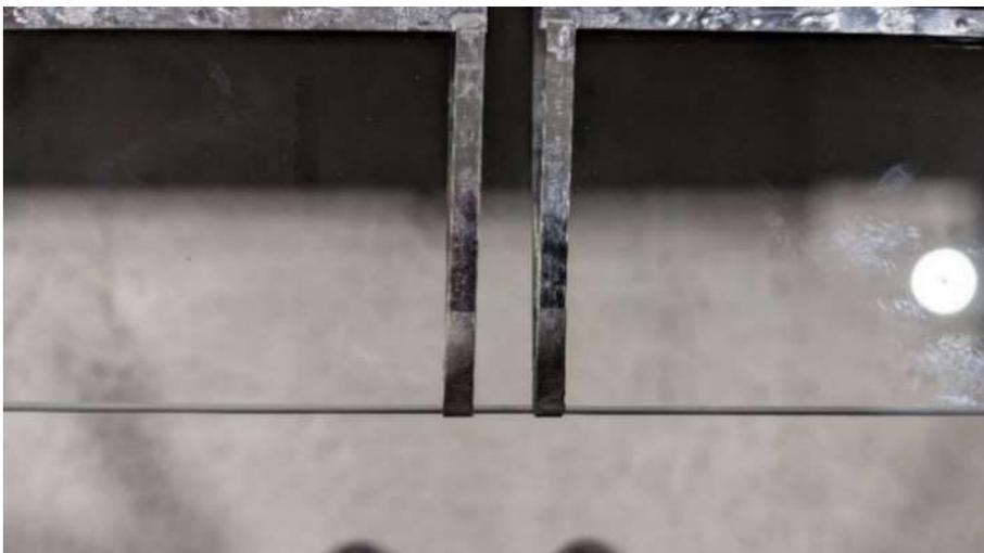
*Abbildung 8: Elektrischer Verbinder isoliert mit Tesa 4129 Klebeband*
