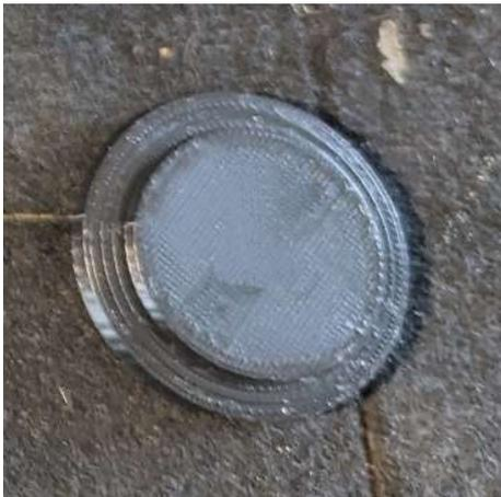
Abbildung 19: 3D-Druck Probekörper für Dichtigkeitstest
