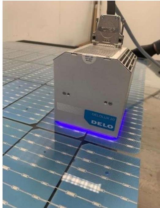
Abbildung 6: UV-Licht aushärtung von Photobond VE557758
