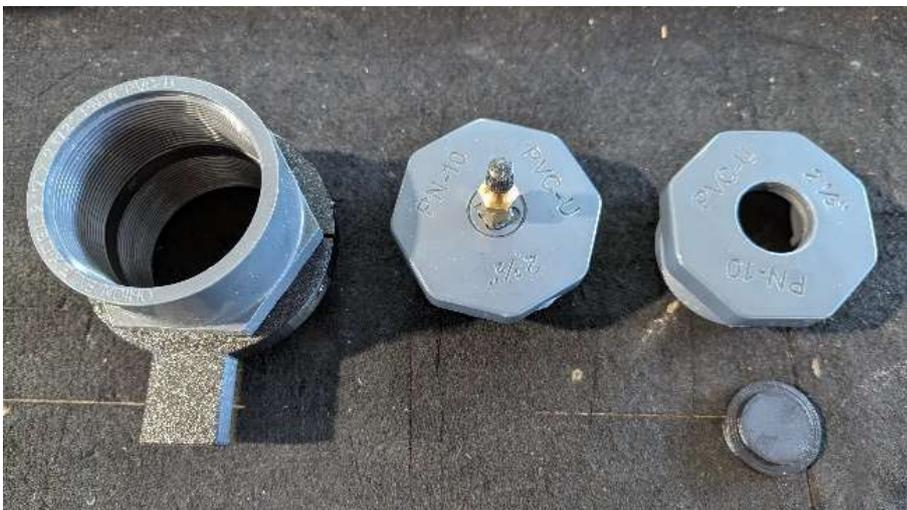
Abbildung 20: Druckbehälter für Dichtigkeitstest von 3D Druck Probekörper
