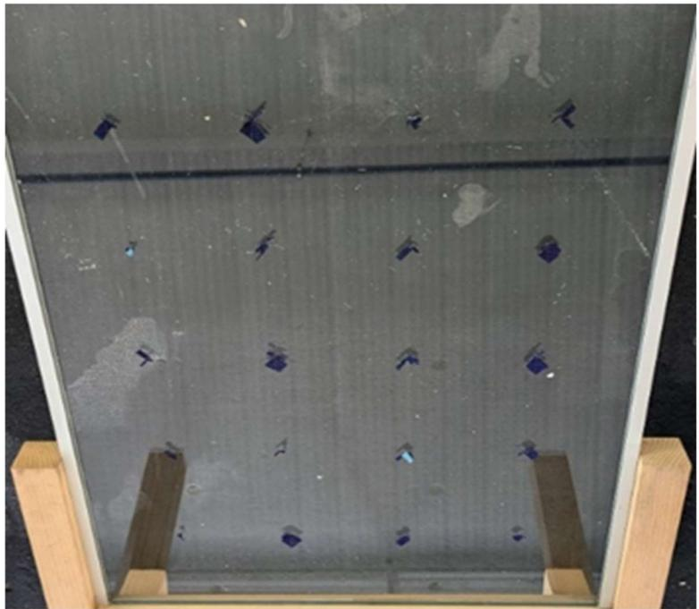
Abbildung 33: Rückstände auf Glas nach Ablöseversuch mit Luftdruck
