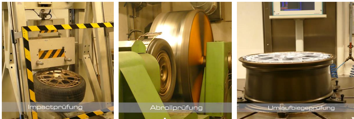
Abbildung 15-17: Radprüfung gemäß KBA-Vorgaben (Richtlinien einer Radprüfung, Quelle: ENTEC-STRACON)
