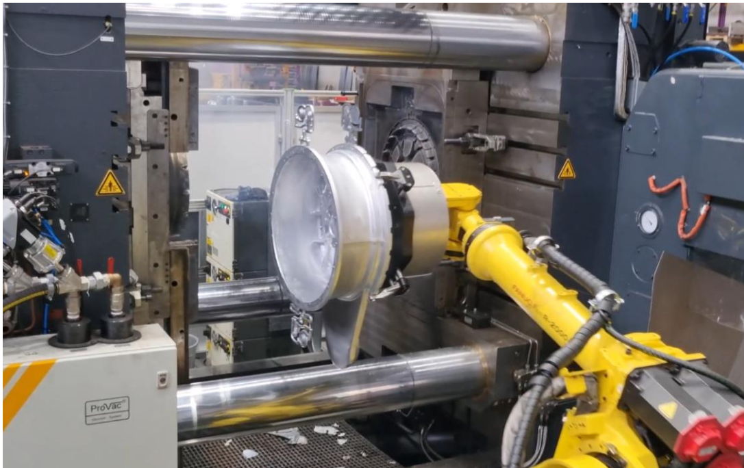
Abbildung 9: Entnahme des Gussteils mittels Robotergreifer, Quelle: ENTEC-STRACON
