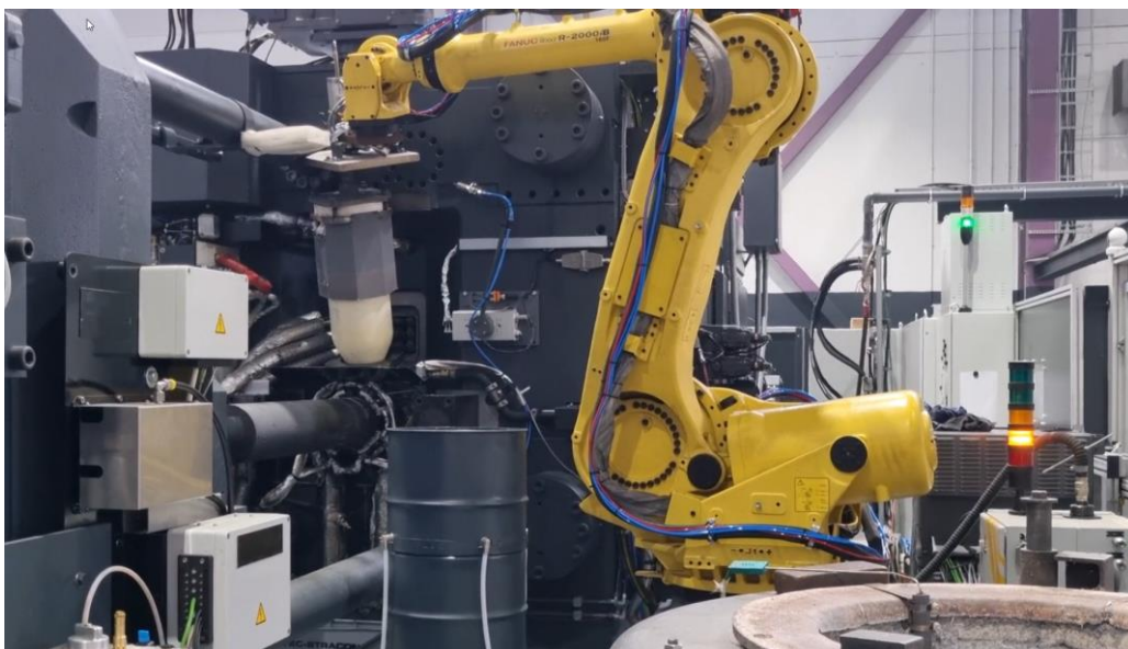
Abbildung 6: Dosieren der Schmelze in die Gießkammer, Quelle: ENTEC-STRACON
