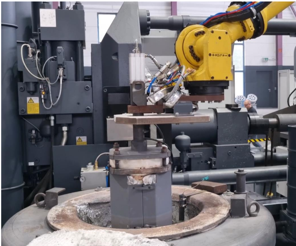
Abbildung 5: Entnahme der Schmelze über eine Dosierglocke, Quelle: ENTEC-STRACON
