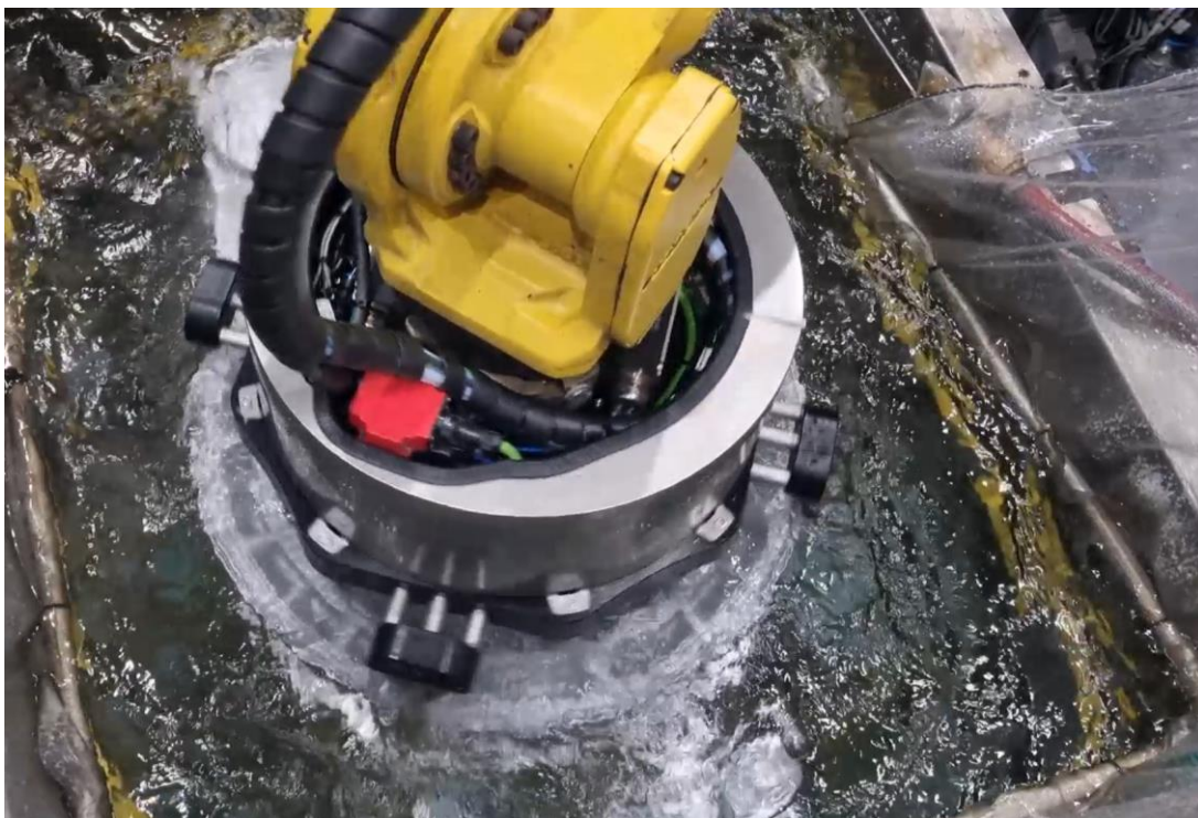
Abbildung 10: Entnahme des Gussteils mittels Robotergreifer, Quelle: ENTEC-STRACON
