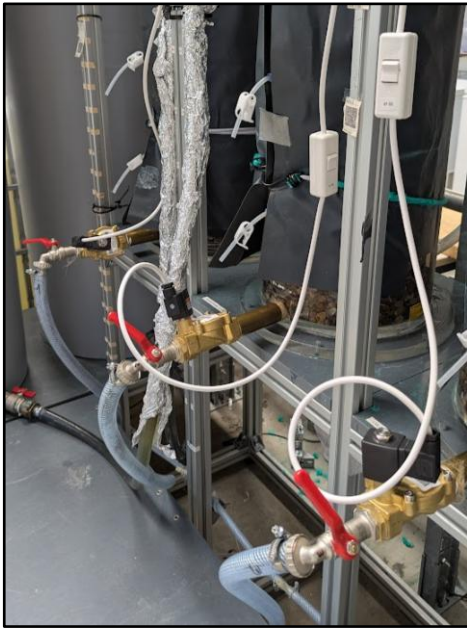
Abbildung 2-11: Magnetventile (stromlos geschlossen) am Ablauf der halbertechnischen Säulen, gesteuert mit Zeitschaltuhren.
