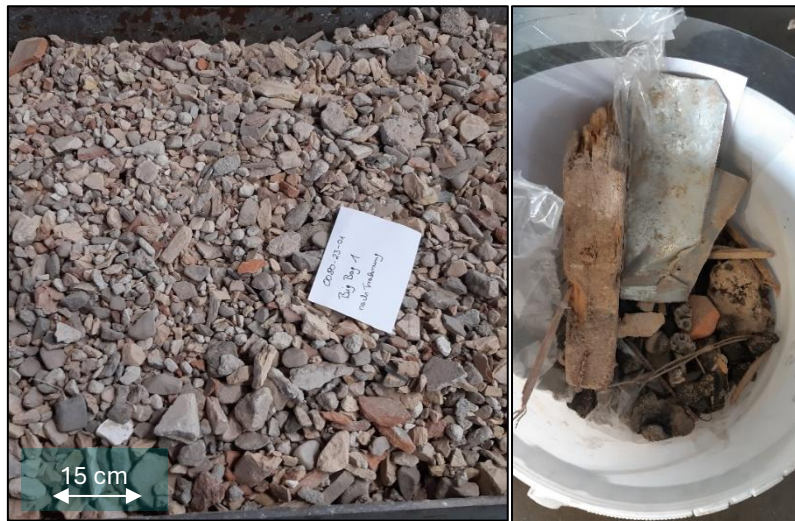
Abbildung 2-2: Mauerwerkbruch MW-D (links) und aussortierte Störstoffe (rechts) (Fotos: UVR-FIA)
