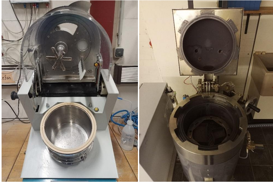
Abbildung 2-4: 1 L-Eirich-Mischer (links) und Laborautoklav (rechts) (Fotos: BAM)
