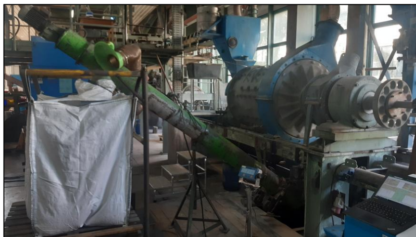
Abbildung 2-3: Durchlaufkugelmühle (L = 1,0 m, D = 0,72 m) (Foto: UVR-FIA)
