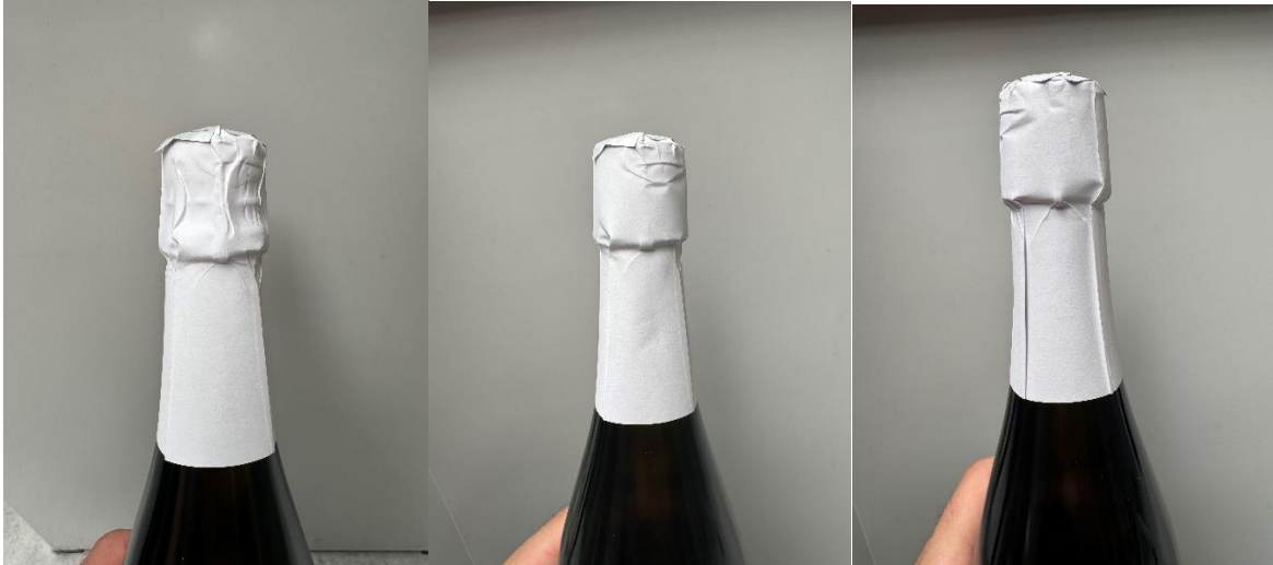
Abbildung 6: Beispiel für die Verbesserung der Prozessparameter bei Versuchen mit glattem Papier. Dabei steigt die Qualität der Faltung von links nach rechts.
