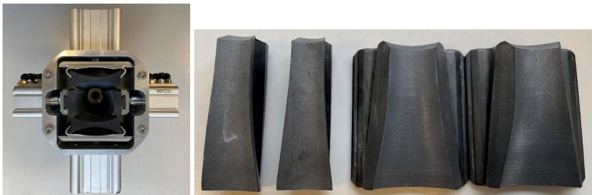
Abbildung 1: Anfallkopf mit einem eingebauten Backensatz (links) und fertig geschliffene Standard-Faltbacken (rechts) nach dem Stand der Technik.
