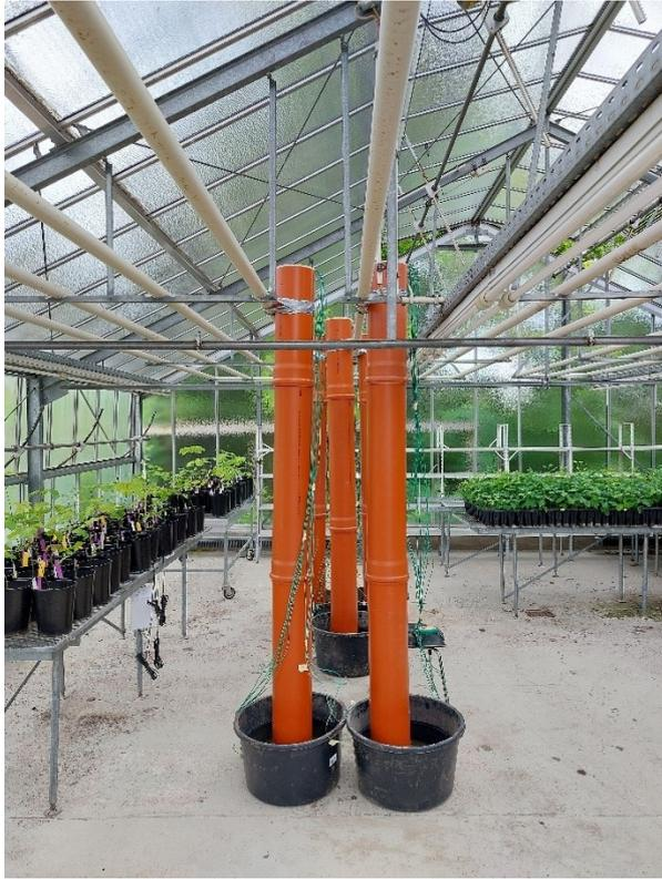
Abbildung 10: Versuchsaufbau an der HAWK Göttingen zum kapillaren Aufstieg.
