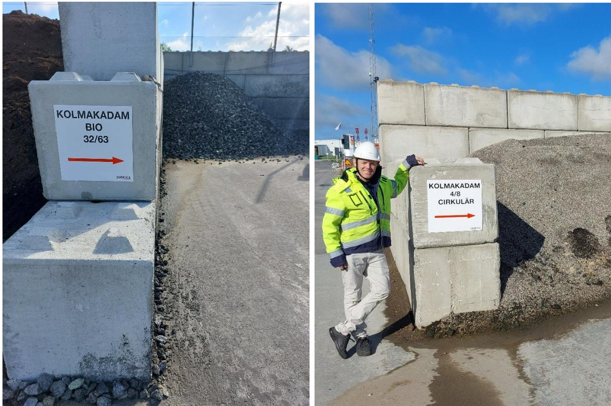
Abbildung 1: Kolmakadam ist der schwedische Begriff für „Pflanzenkohle-Schotter“. Auf dem linken Foto die grobere Mischung für den erweiterten Wurzelraum, rechts auf dem Foto die feinere Mischung für Pflanzgruben, Beete, Fassadenbegrünungen, Kübelpflanzungen und vieles mehr.
