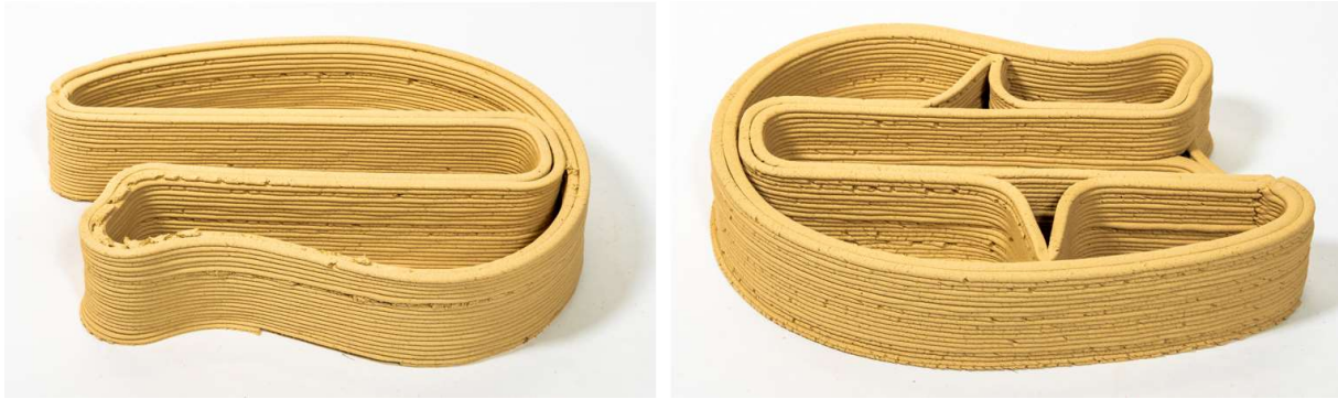
Abbildung 16: Zweibahnige Zargen mit funktionaler Innenstruktur
