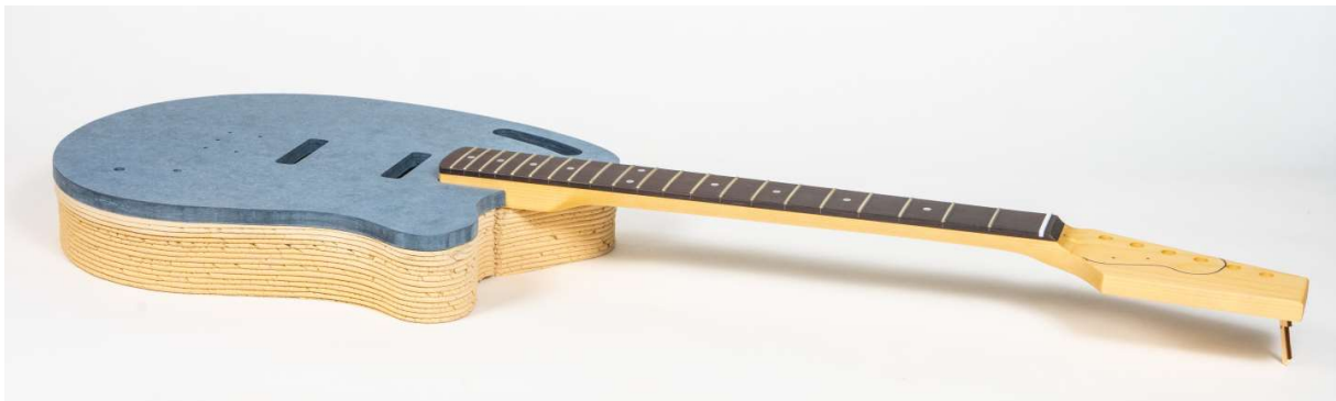
Abbildung 17: Additiv gefertigte Zarge mit Deckel und eingepasstem Gitarrenhals
