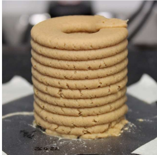
Abbildung 2: 3D-gedruckter Prüfkörper der Mischung ZL:KL:W:H = 1:2:13:3,7 zur Bestimmung der Materialschwindung
