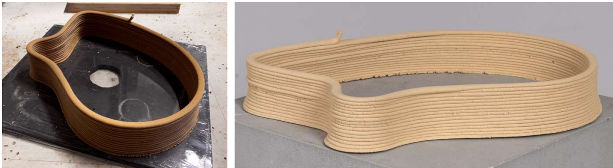
Abbildung 13: Einbahnige, im Vasenmodus gefertigte Zarge mit Qualitätsproblemen im Bereich langer, relativ gerader Wandbereiche
