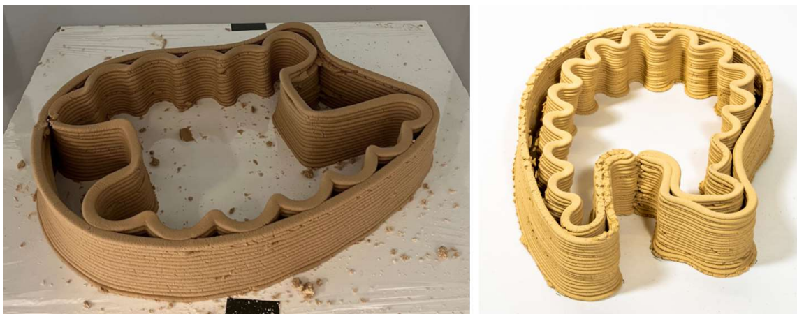
Abbildung 15: Zweibahnige, im Vasenmodus gefertigte Zarge mit wellenförmiger, innerer Stützstruktur
