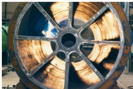
Abbildung 1: Querschnitt eines Drehrohres mit Sektionaleinbauten
