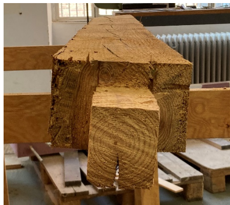
Abbildung 4: Theoretisch nutzbarer Restquerschnitt eines Balkens der Reihe I
