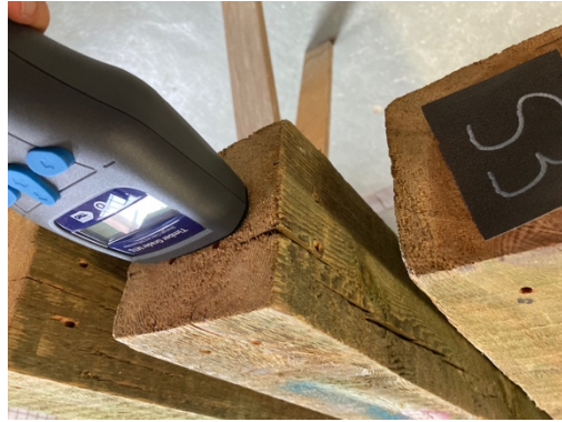
Abbildung 6: Bestimmung des Elastizitäts-Moduls und der Festigkeitsklasse mit dem Timber Grader
