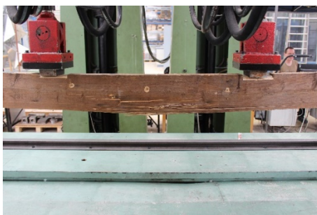
Abbildung 9: Versagensbild und Arbeitslinie eines Probekörpers
