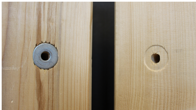
Abbildung 21: Beispielhaftes Versagensbild der Geometrie IV-c, Querdruckversagen bei der Lagesicherung
