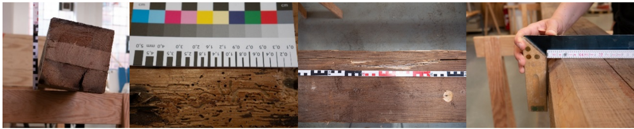
Abbildung 3: Sortierung der Altholzbalken: Zum Ausschluss führende Kriterien mechanische Schädigung, Insektenfraß, Baumkante, Verdrehung
