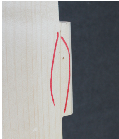
Abbildung 19: Beispielhaftes Versagensbild der Geometrie I-b, Versagen in der Scherfuge
