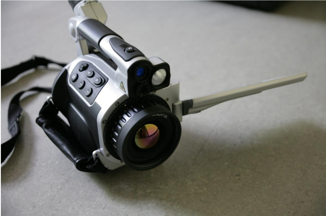
Abbildung 10: Verwendete Wärmebildkamera - Infratec VarioCam HD 900
