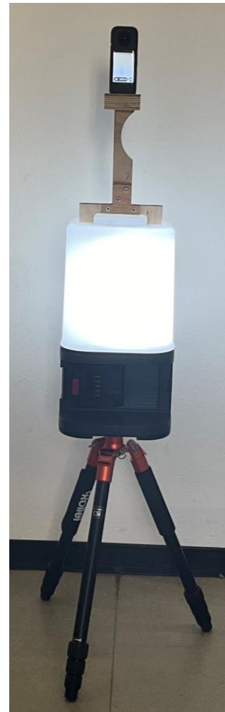
Abbildung 4: Setup zur Aufnahme der 360°-Fotos
