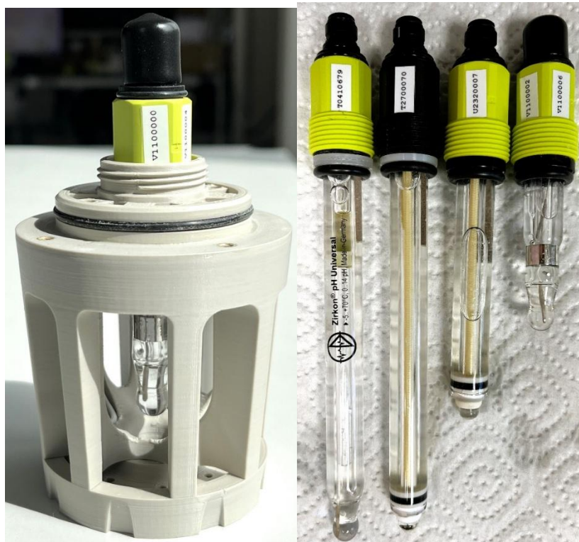
Abbildung 6: Fotografie des kleinen Sensors, eingebaut in die Messvorrichtung (links) Größenvergleich der verschiedenen Sensorstadien (rechts)
