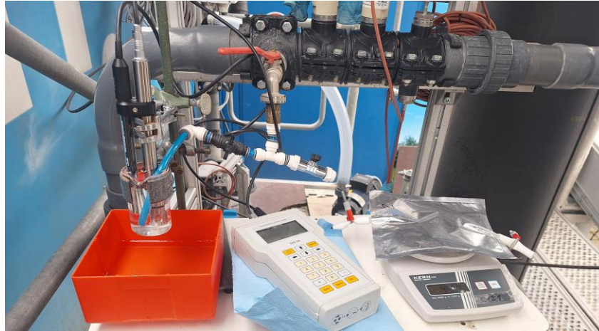
Abbildung 8: Messaufbau zur Bestimmung der H_2 -Konzentration mittels H_2 -Elektrode in einer kontinuierlich vom Boden aufwärts durchströmten Messzelle (links) und der Flüssigkeitsprobenahme aus dem geschlossenen System gemäß Methode in Abschnitt 0 (rechts).
