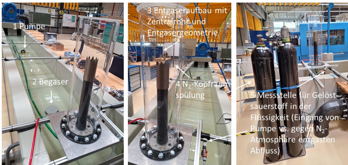
Abbildung 31: Labor-Versuchsaufbau zur Untersuchung der Entgasungseffizienz verschiedener Entgaser-Geometrien.
