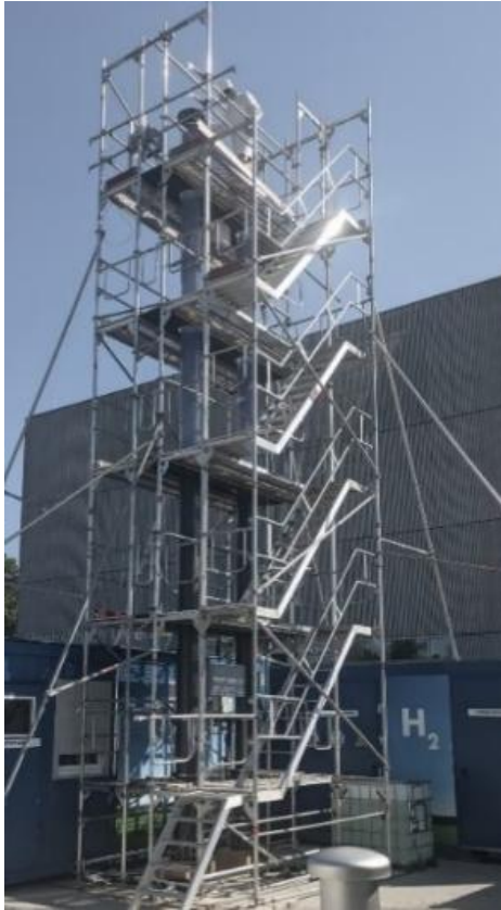
Abbildung 3: Technische Umsetzung des Verfahrenskonzeptes mit einem Reaktionsvolumen von ungefähr 1,1 \text{ m}^3 .
