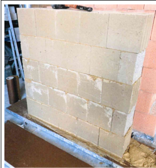
Abbildung 103: RILEM -Körper nach Herstellung, Format 8DF
