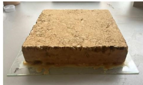
Abbildung 21: Mit Paraffin abgedichteter Probekörper
