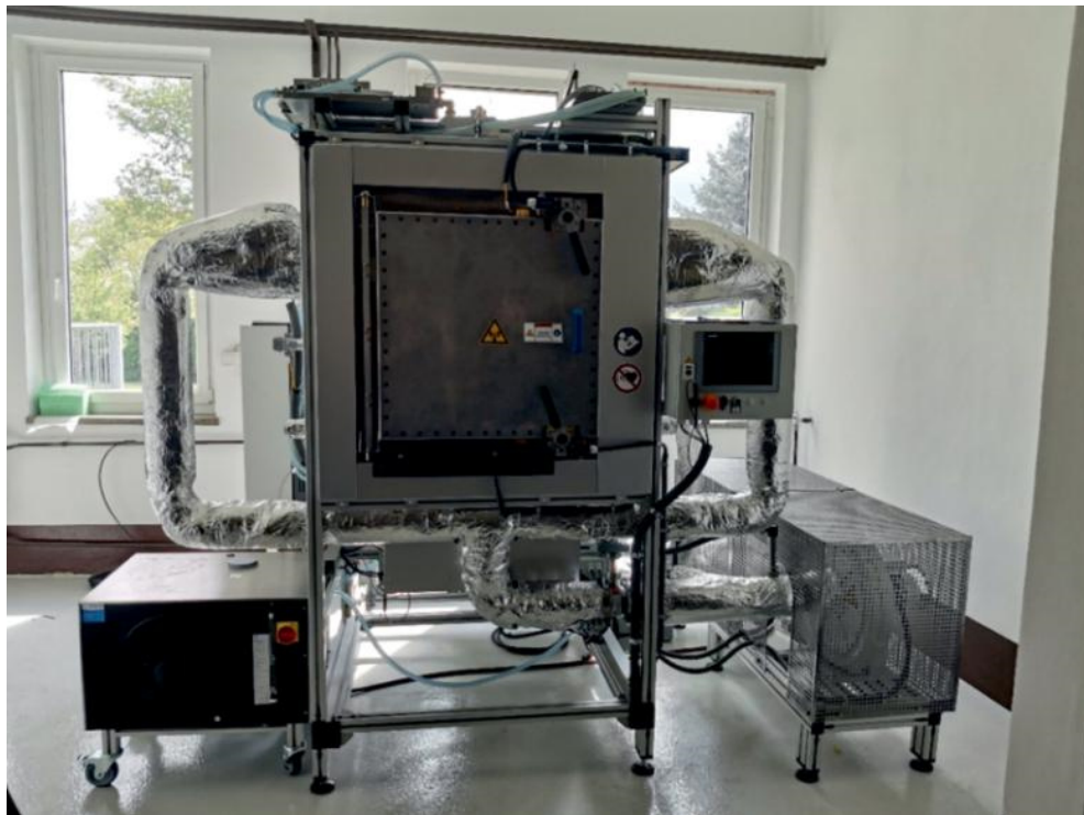
Abbildung 87: Leistungsmikrowellenanlage mit Luftkonditionierung und Sensorik an der MFPA
