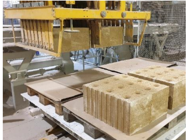
Abbildung 12: Lehmsteine nach Pressvorgang – hier Format 4DF (240) mit Abbildung 13: Stapeln der Lehmsteine auf Härtewagen - hier Format 6DF (175)
