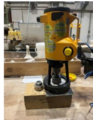
Abbildung 28: Auf den Probekörper aufgesetztes Haftzugprüfgerät
