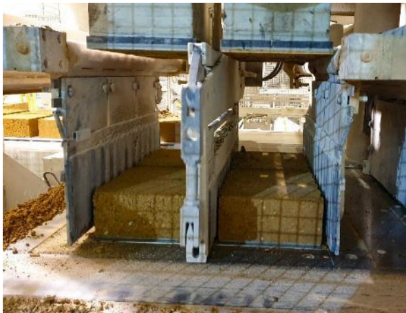
Abbildung 12: Lehmsteine nach Pressvorgang – hier Format 4DF (240) mit Abbildung 13: Stapeln der Lehmsteine auf Härtewagen - hier Format 6DF (175)
