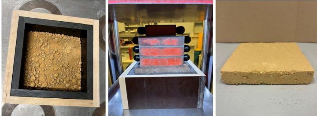
Abbildung 24: Herstellung der Prüfkörper – links: Vorverdichtung auf dem Rütteltisch, mittig: Verdichtung in der hydraulischen Presse, rechts: gepresster Lehmsteinprüfkörper
