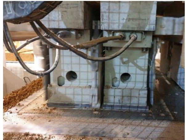
Abbildung 10: Gefüllter Formkasten mit Produktionslehm mit Abbildung 11: Pressvorgang
