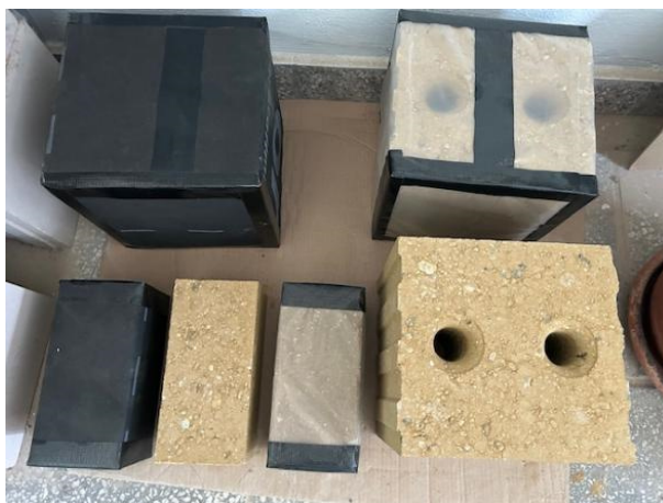
Abbildung 91: Trocknungsversuche Lehmsteine in Folie
