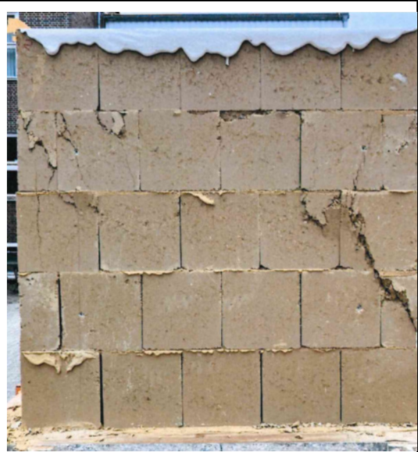
Abbildung 104: RILEM-Körper nach Prüfung, Versagensbild
