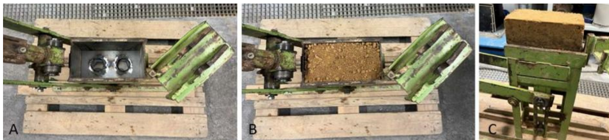
Abbildung 26: Herstellungsschritte der Prüfkörper mit der Kniehebelpresse unter Verwendung des Metall-Einsatzes (A); Befüllung des Formkastens mit Lehm (B) und gepresster Lehmstein (C)
