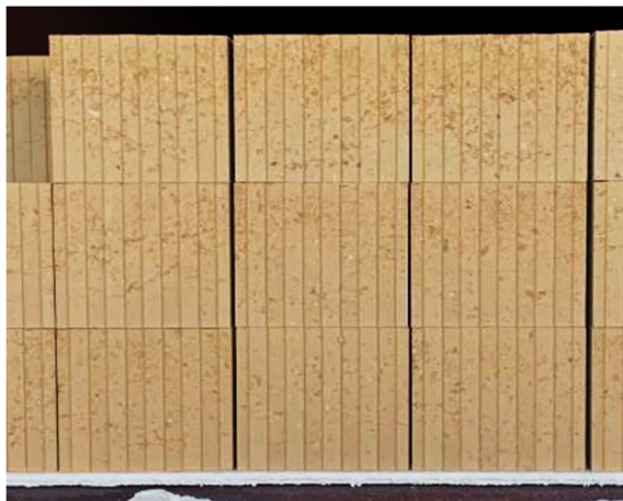
Abbildung 8: Horizontalschliff infolge zu feuchten Produktionslehmes Abbildung 9: Entmischung - Produktionslehm zu trocken
