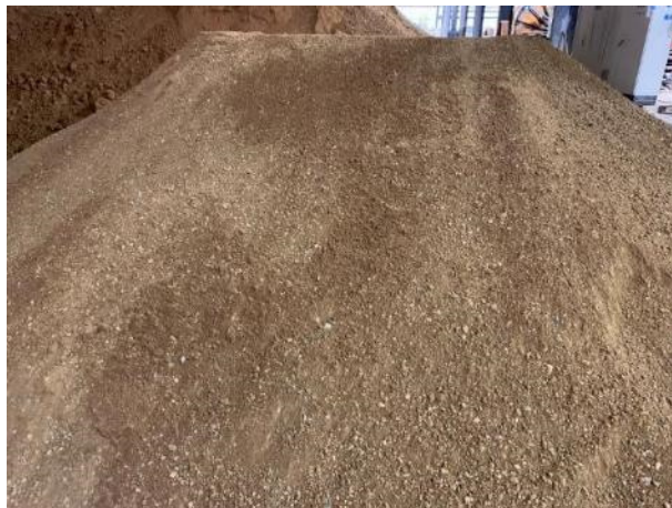
Abbildung 7: Lehm fein nach der Aufbereitung
