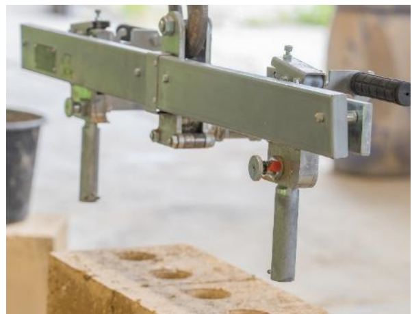
Abbildung 97: Versetzzange: Modell Lissmac VSG 840 Vario-Steingreifer mit Vario-Wechselbacken B30 Porenbetonsteine
