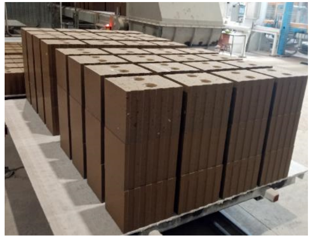
Abbildung 84: Stapelung Vollsteine in 3 Lagen - hier 10 DF – Versuch Variation Stapelbild - Spalt auch in Querrichtung
