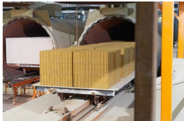
Abbildung 15: Einfahrt der Steine in den Autoklaven zur Trocknung. Die Steine trocknen durch Abwärme der benachbarten Autoklaven, die Deckel bleiben geöffnet.
