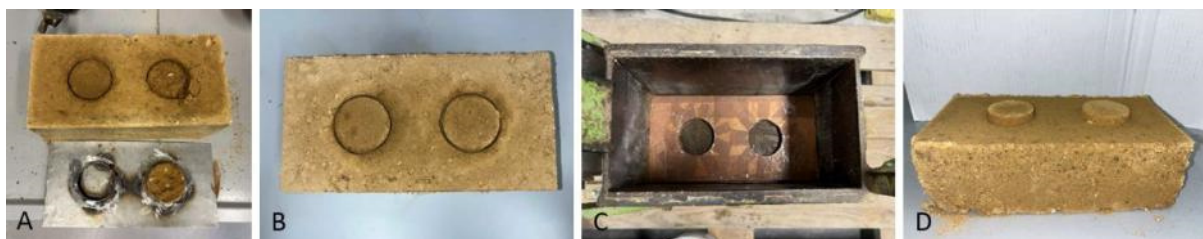
Abbildung 27: Ausgebrochene Prüffläche am Lehmstein und Lehmreste an der Schablone (A); Prüfkörper nach ausreichend Befeuchtung mit Wasser (B); Holzeinsatz (C) zur Herstellung von Prüfkörpern mit Noppen (D)
