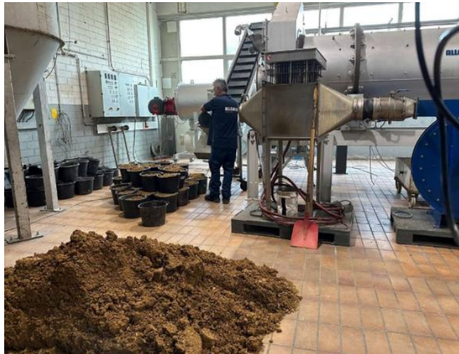
Abbildung 78: Lehm-trocknungsversuche im Technikum Fa. Allgaier
