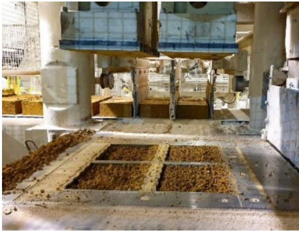
Abbildung 10: Gefüllter Formkasten mit Produktionslehm mit Abbildung 11: Pressvorgang
