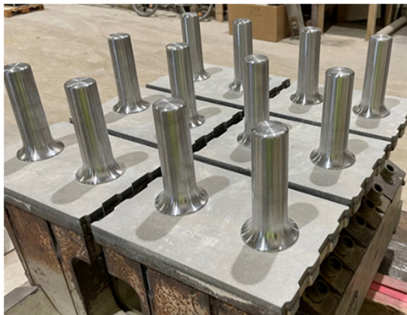
Abbildung 96: Modifiziertes Formwerkzeug mit langen Dornen für Steinhöhe 248mm
