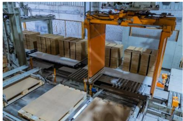
Abbildung 16: Paketierung - Umsetzen der Steine von Härtewagen auf Europaletten
