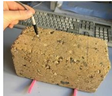
Abbildung 31: Versuchsaufbau Hammer-Schlag- Verfahren
