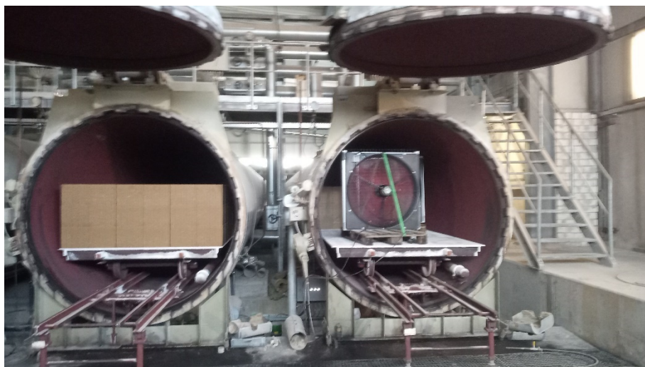
Abbildung 82: Vergleich Trocknung Lehmstein 10DF mit und ohne Ventilator
