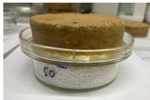
Abbildung 23: Versuchsaufbau zur Bestimmung der Wasserdampfdurchlässigkeit
