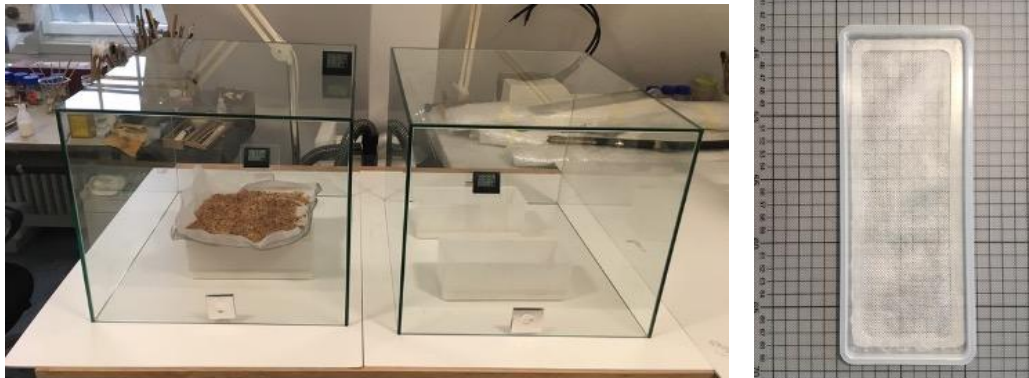
Abbildung 18 a-b: Glashauben mit Versuchen zum „Tandemsystem“ und mit semi-permeabler Membran (Tyvek®).
