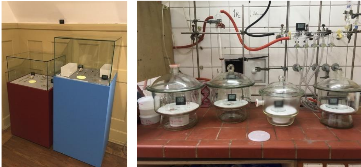
Abbildung 19: (links) Zwei Vitrine bestückt mit Schwefel, Silberobjekten und Kupfercoupons, eine davon zusätzlich mit GKCL. (rechts) Demonstrationsversuch zur Schadstoffabsorption durch GKCL, Universität Hamburg.
