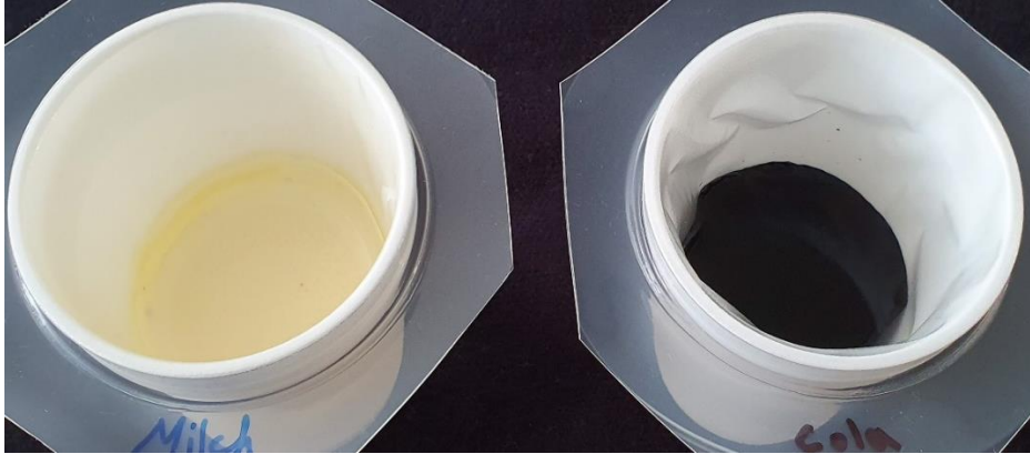
Abbildung 9: Aromatests mit Milch (links) und Cola (rechts) im Contentlayer für 48 h
