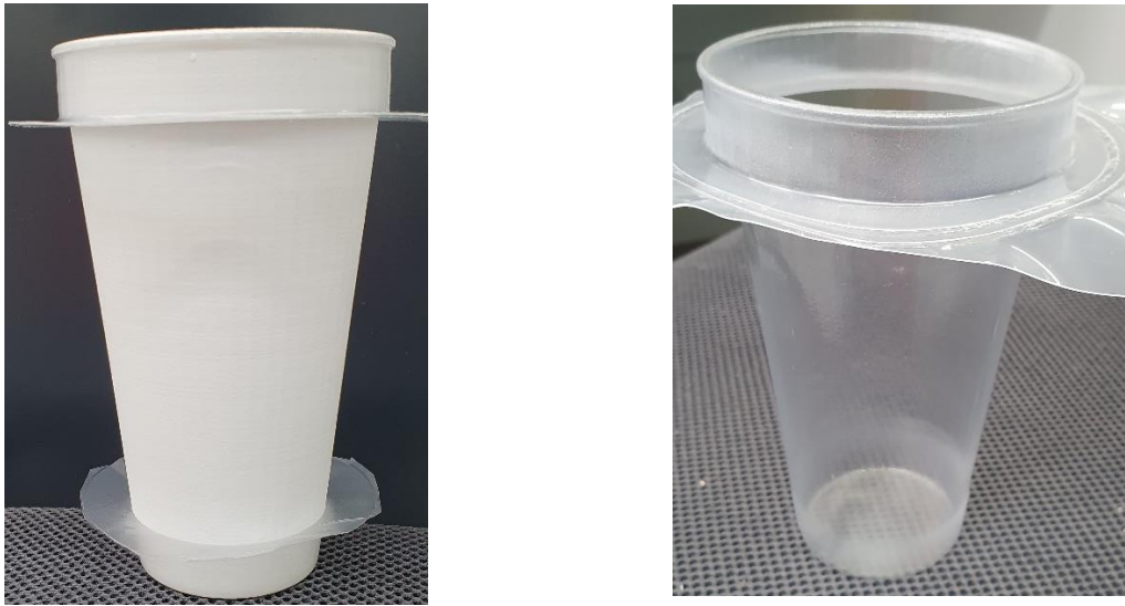
Abbildung 8: 500 ml Becher mit Contentlayer, der über den Trinkrand hinausragt und mit dem separat hergestellten Boden (links), herausnehmbarem Contentlayer (Innenlayer) (rechts)
