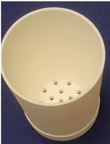
Abbildung 6: Werkzeugeinsatz zum Tiefziehprozess für 500 ml Becher
