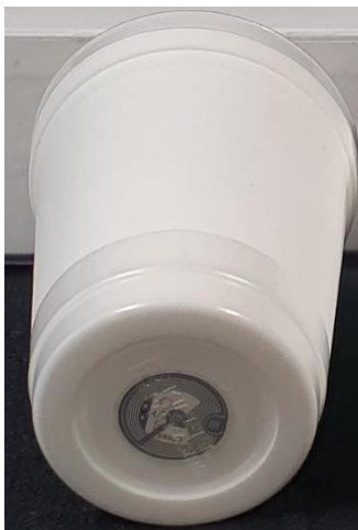
Abbildung 13: Anbringung des NFC-Chips am Boden des IQPAKs
