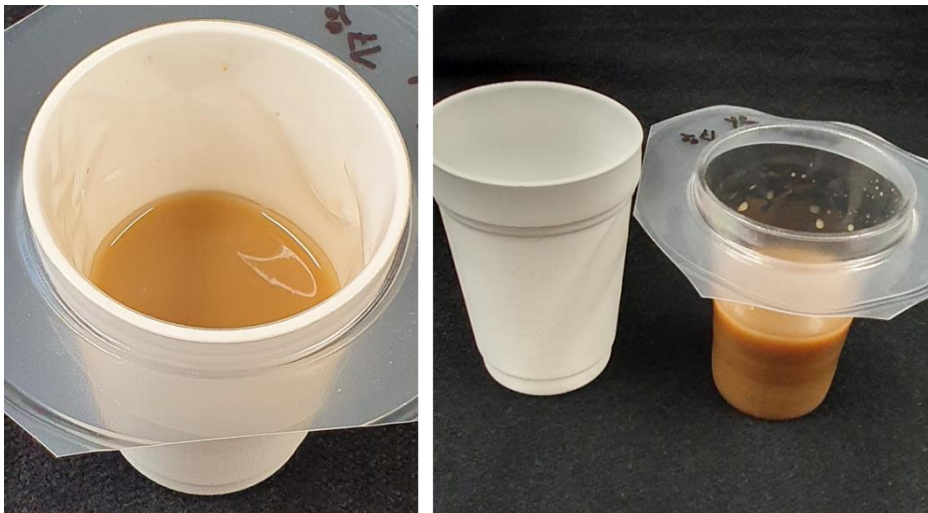
Abbildung 10: Milchkaffee im Contentlayer für 48 h (links); Aromatest mit dem Systemlayer (rechts)
