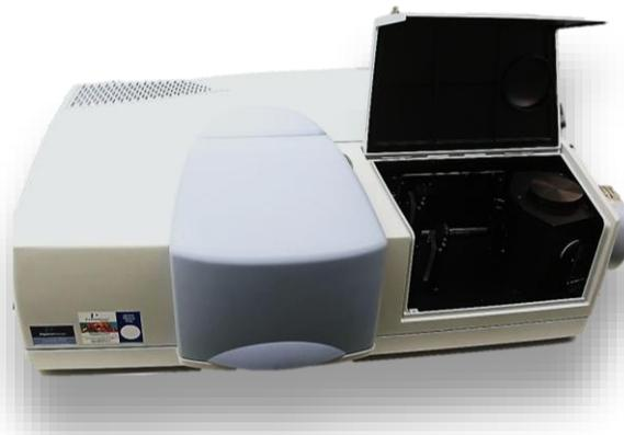
Abbildung 5: Zweistrahl-Spektrophotometer der Firma Perkin Elmer Lambda 1050 mit Ulbrichtkugel (Quelle HSRT).
