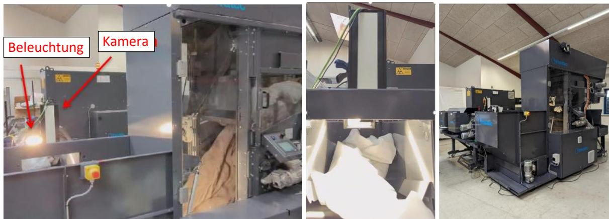
*Abbildung 25: Implementierung des NIR-Labormesssystems in die Sortiermaschine. Links: Gesamtaufbau mit Kamera, Beleuchtung und Steuerrechner. Mitte: Details der Beleuchtung. Rechts: Übersicht des Sortiersystems (Quelle: HSRT).*
