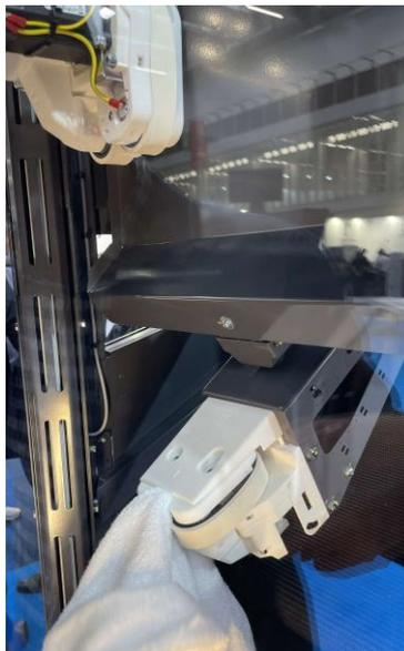
*Abbildung 3: Zwei-Greiferprinzip des Sortierroboters (Inwatec ApS) mit Transportbandtechnologie: links oben 3D-Greifarm zum Aufheben des Textilstücks, Mitte unten starrer Greifarm zum seitlichen Wegziehen des Textilstücks und Ablegen auf das Transportband (Messestand Jensen-Group auf Texcare International 2024, Frankfurt).*
