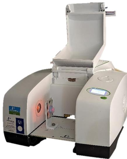
Abbildung 7: FT-NIR-Spektrophotometer der Firma Perkin Elmer Frontier mit Zubehör für die kollimierte Transmission (Quelle: HSRT).
