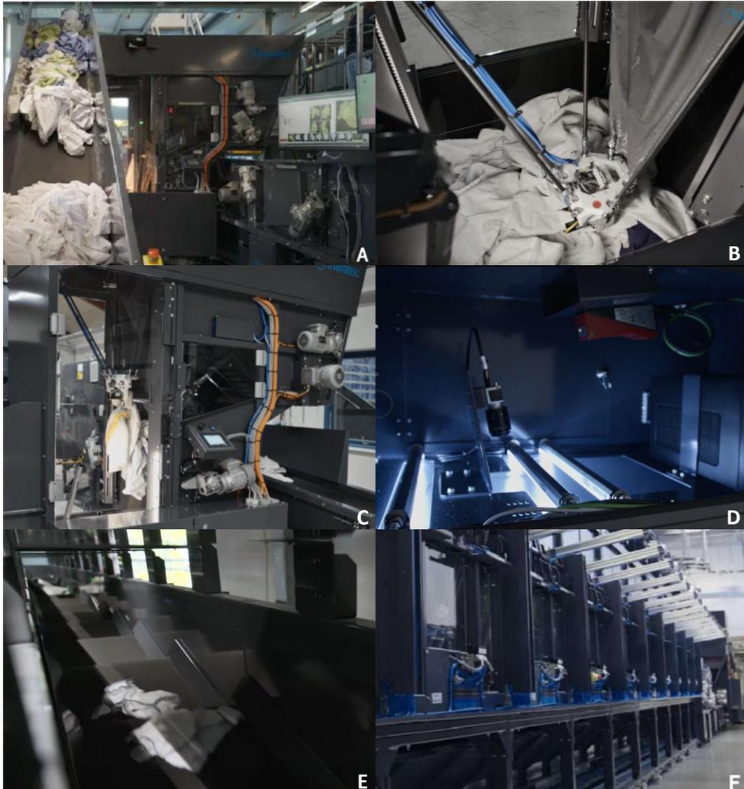
Abbildung 4: Prinzipieller Workflow der maschinellen Textilsortierung für Antransport (A), Vereinzeln & selektive Weitergabe (B & C), (KI-NIR-) Detektion (D), Weiterförderung (E) und die kategorisierte Sammlung (F) der Alttextilien (Quelle: Inwatec ApS).
