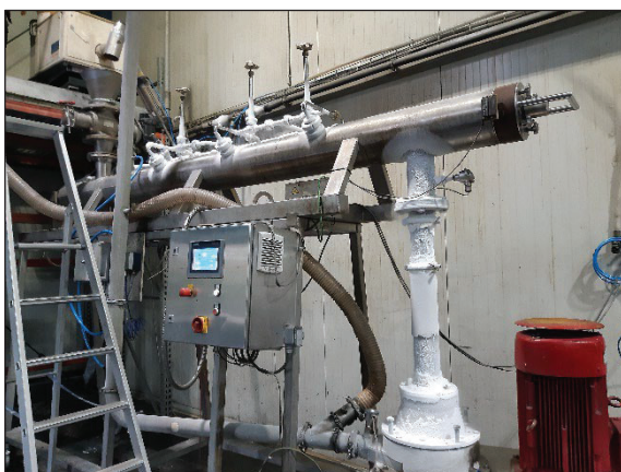
Abbildung 15: Kryogenschnecke mit Prallstrommühle
