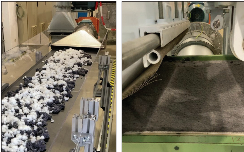
Abbildung 37: li.: Förderband mit grauer Handschuh-Rezyklat und weißen Biko-Fasern, re.: Faserflor
