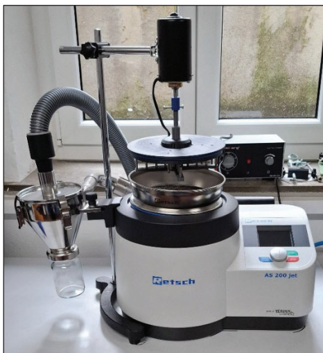
Abbildung 26: Luftstrahlsiebmaschine mit Kammstabdeckel, Maschensieb und Zyktronbehälter
