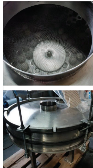
Abbildung 23: Vibrationssiebmaschine mit Ultraschallaufsatz
