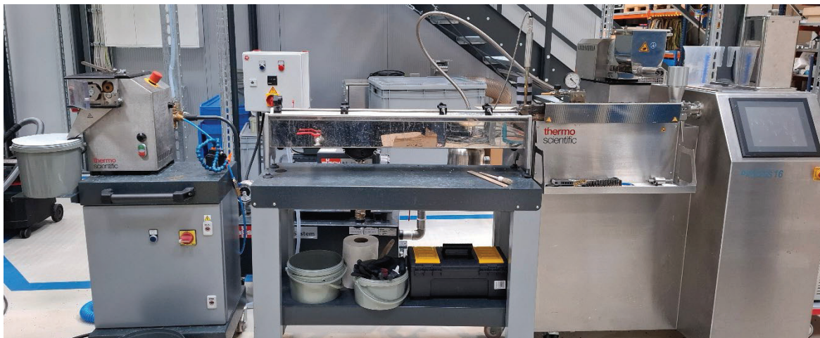
Abbildung 32: Doppelschneckenextruder „Process 16“ beim IKK, Hannover
