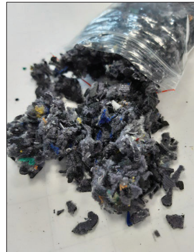
Abbildung 5: Handschuh schneidgemahlen auf ca. 8 bis 10 mm
