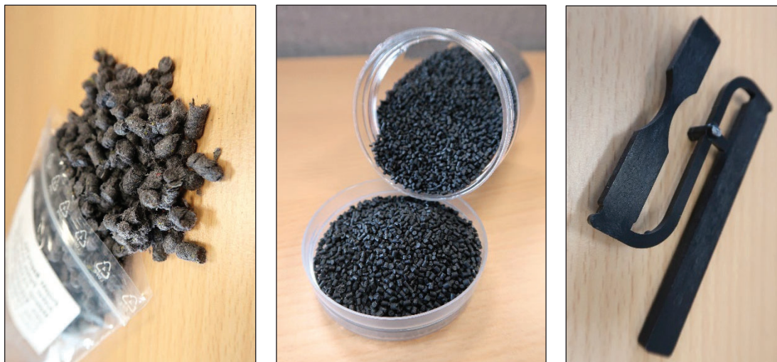
Abbildung 33: li.: PA/NBR-Pellets, mi.: PA/NBR-Granulat, re.: PA/NBR-Spritzgussteil
