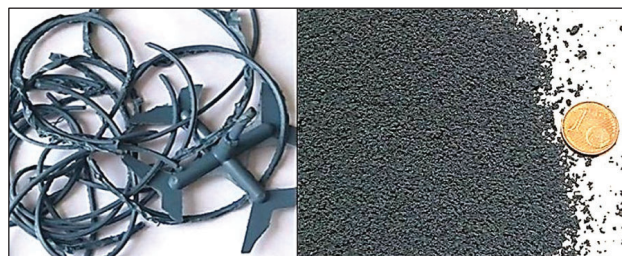
Abbildung 7: NBR-Reststoff vor (li.) und nach (re.) Verarbeitung im Warmmahlextruder (Quelle: TU Chemnitz, 2014)
