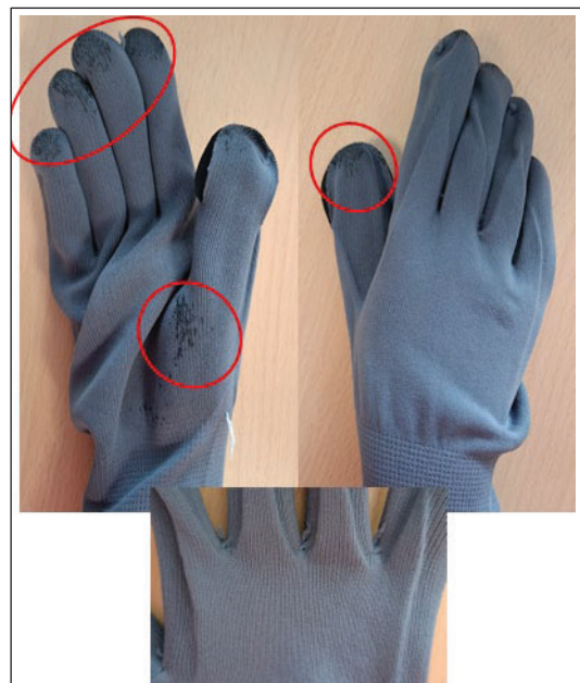
Abbildung 35: durchgedrückte Beschichtung Innenseite
