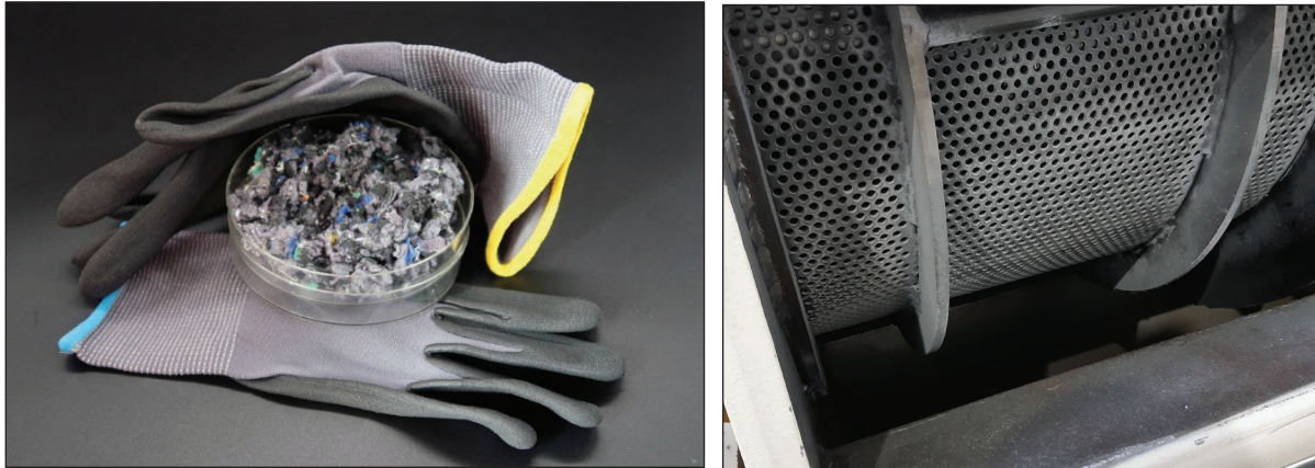
Abbildung 12: li. Handschuhe im Ganzen und schneidgemahlen, re.: Schneidsieb
