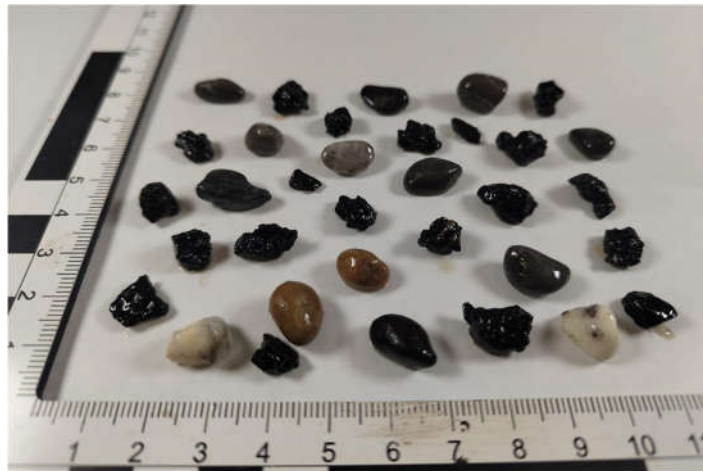
Abbildung 3: Visuelle Gegenüberstellung von wasserbenetztem Asphalt und dunkler Mineralik (Schwarze Mineralik). Die minimale farbliche Differenzierung verdeutlicht die Herausforderung für die optische Detektion im nassen Zustand. (Foto: Mischa Tschopp, UMTEC)
