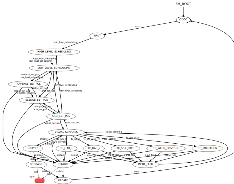
Abbildung 11: State Machine - Gesamtsystem
