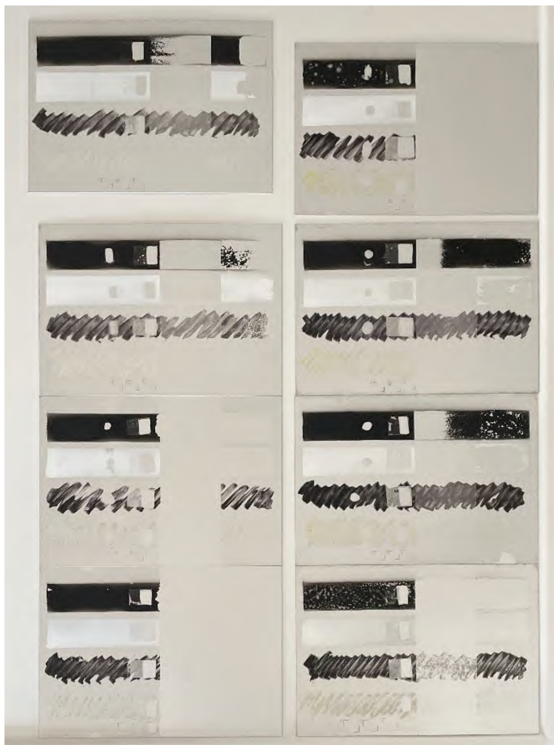
Abb. 66: Testplatten S2 = anodisiertes Aluminium.
