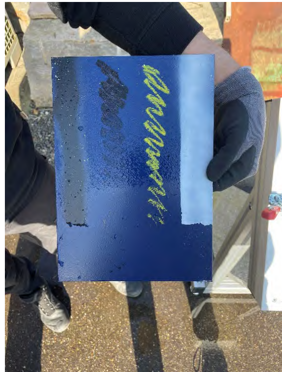
Abb. 21: Vortestplatte (S1) nach dem Strahlen mit Hochdruck.
