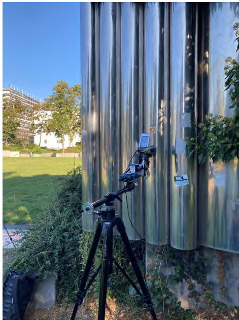
Abb. 2: Untersuchung in situ mit RFA, Fallbeispiel 5.
