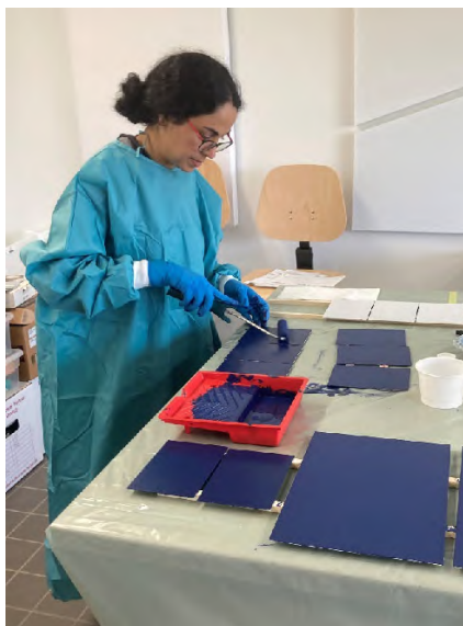
Abb. 5: Auftrag der Deckbeschichtungen (S1).
