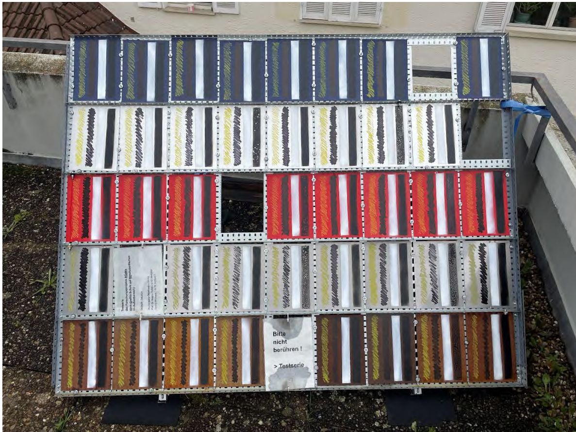
Abb. 16: Testreihe mit Graffiti in Freibewitterung, Zustand im Oktober 2024.
