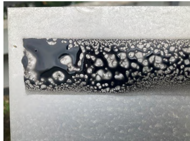
Abb. 15: Platte S4_AGS4: Bläschenbildung bereits während des Graffiti-Auftrags.
