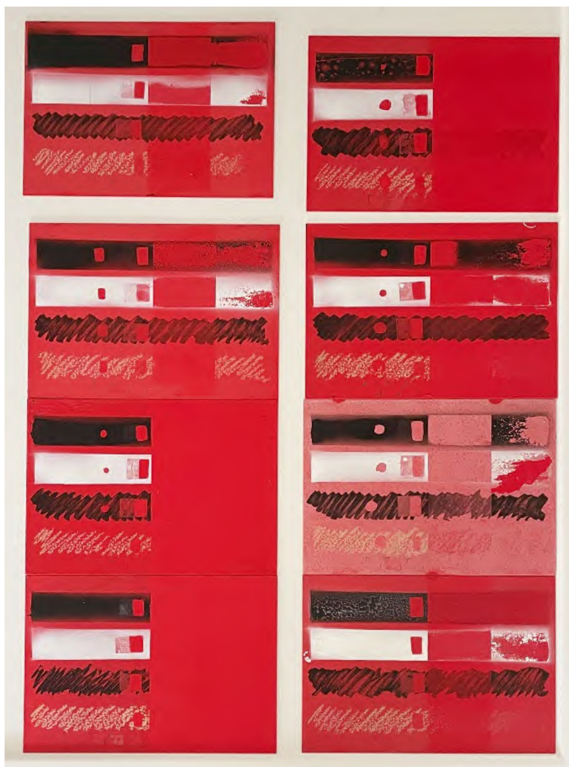
Abb. 67: Testplatten S3 = Alkydlack beschichteter Stahl.
