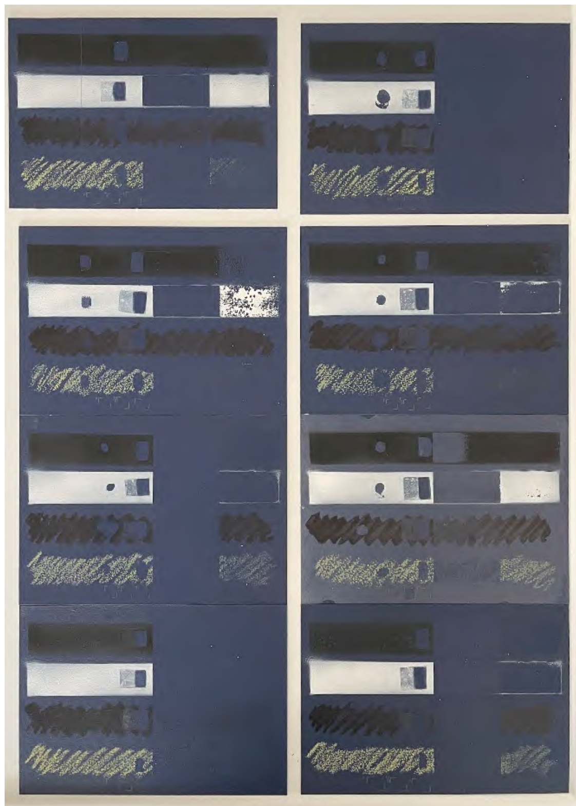
Abb. 65: Testplatten S1 = PU-beschichtetes Aluminium.
