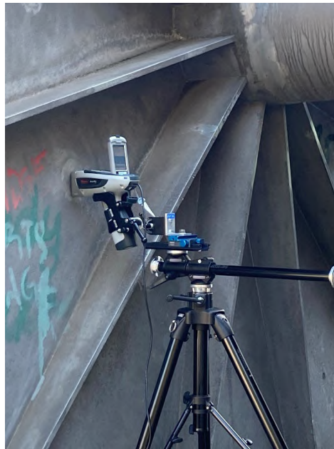
Abb. 3: Untersuchung in situ mit RFA, Fallbeispiel 13.
