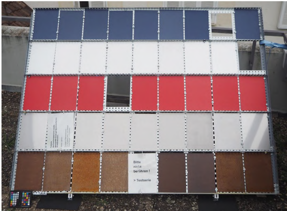
Abb. 8: Testreihe in Freibewitterung, Zustand im September 2024.
