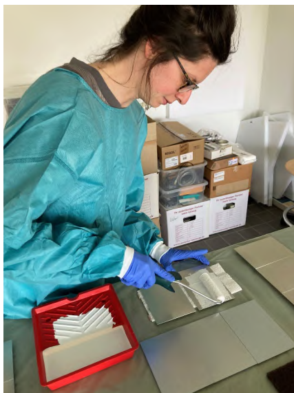
Abb. 4: Auftrag der Grundierungen auf den Metallplatten.
