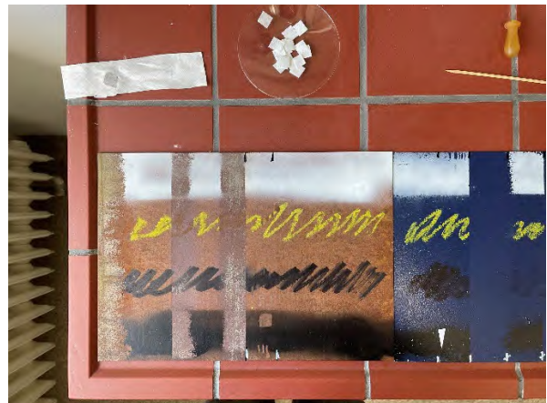
Abb. 23: Reinigungstests mit Kompressen (R3) auf den Vortest-Platten.
