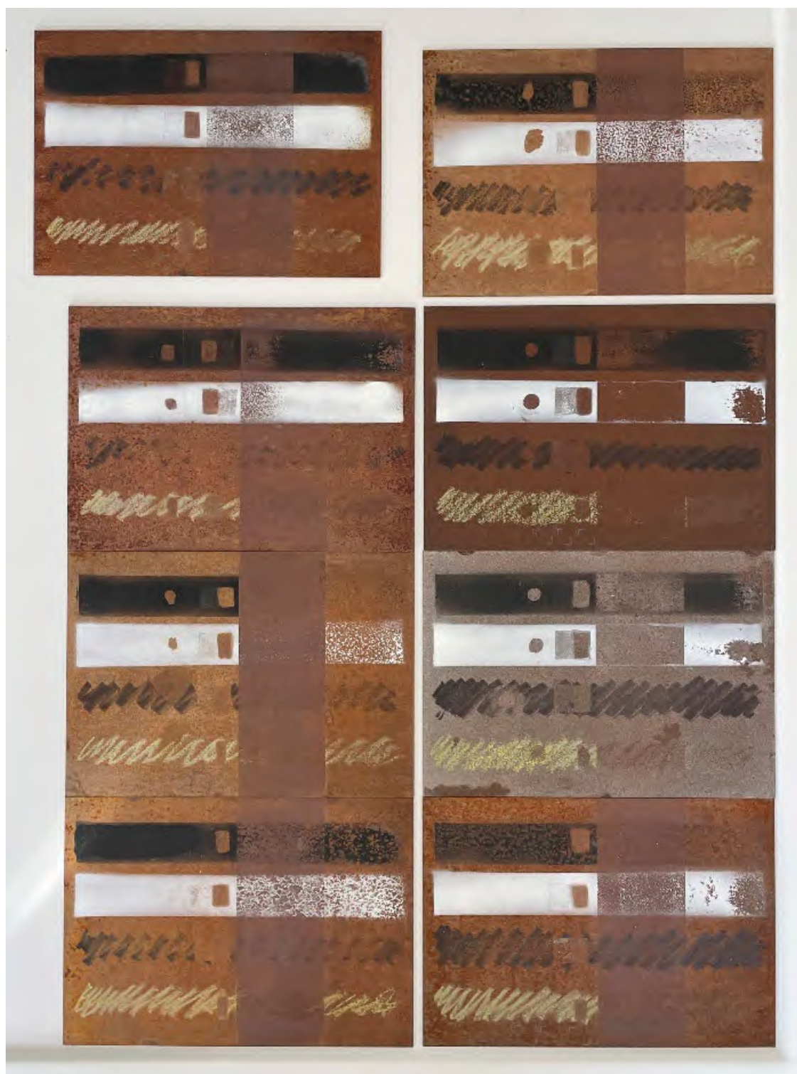
Abb. 69: Testplatten S5 = wetterfester Baustahl (Corten).
