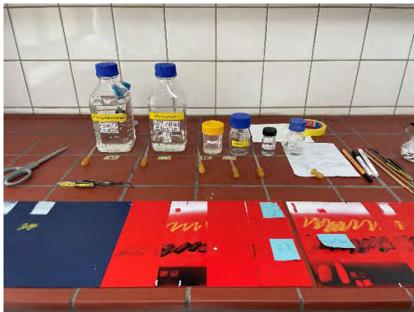
Abb. 22: Reinigungstests mit Lösemitteln (R3) auf den Vortest-Platten.
