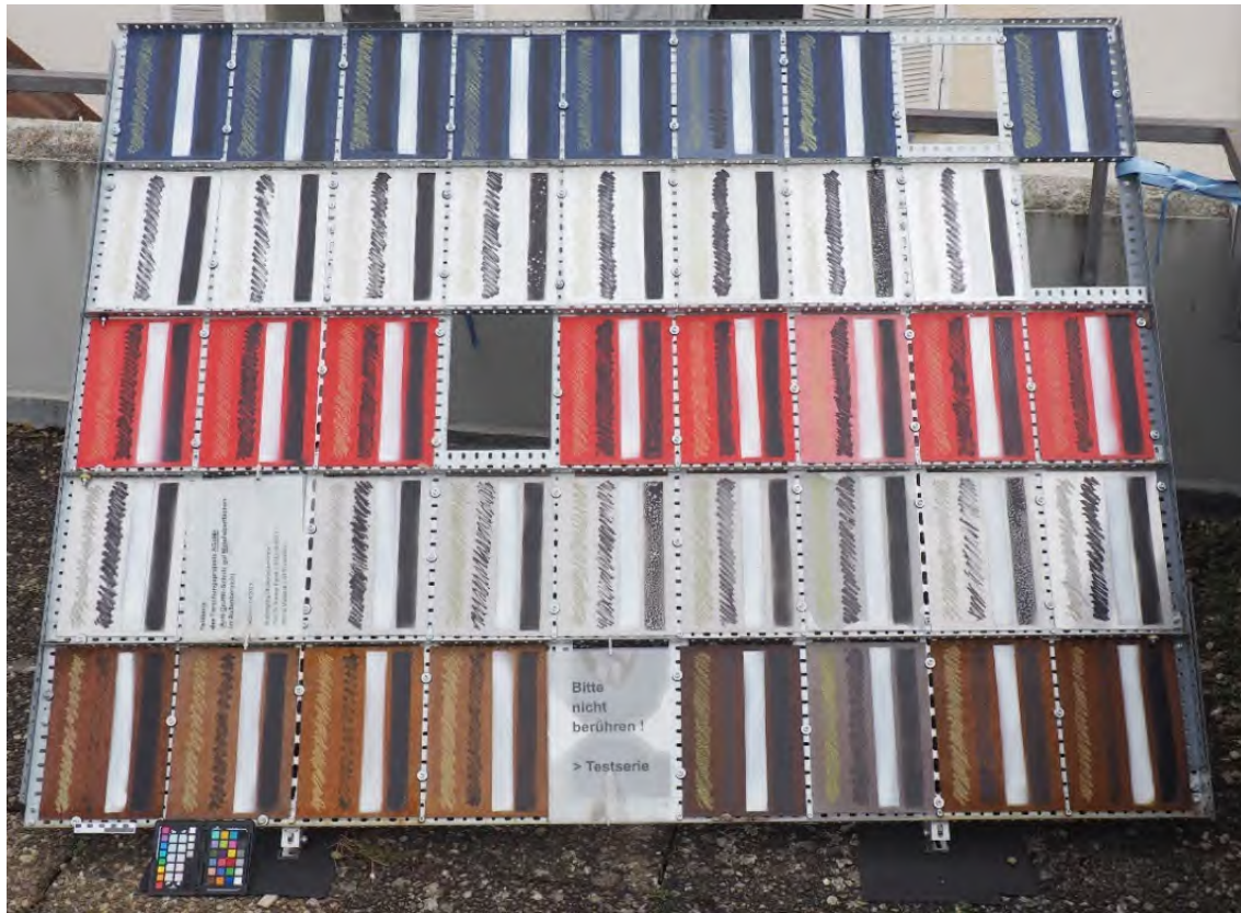
Abb. 19: Testreihe in Freibewitterung, Zustand im März 2025.
