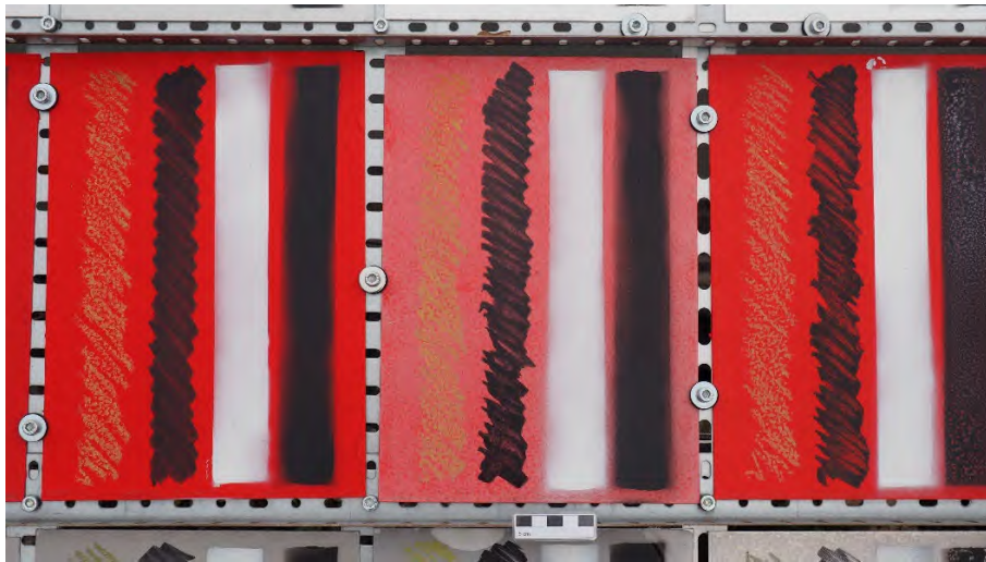
Abb. 17: S3_AGS6 (links), S3_AGS7 (mittig), S3_oAGS (rechts): Milchige Erscheinung der Oberfläche im Vergleich, hier bei mittlerer Platte S3_AGS7.
