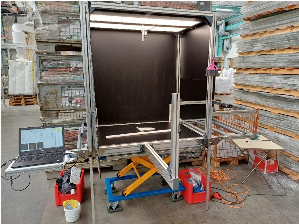
Abbildung 8: Prüfstand aufgebaut bei Pekutherm für die Erfassung von PMMA-Charakteristiken
