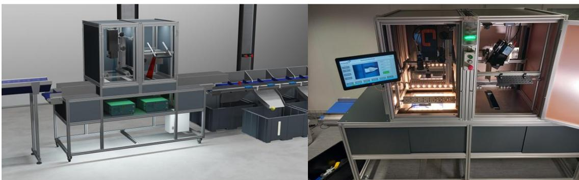
Abbildung 25: Rendering der Sort4Circle-Versuchsanlage (mit optionaler Zuführung und Ablageeinheit) und Blick in die reale Anlage mit NIR-Messkammer (links) und Marker-Messkammer (rechts)
