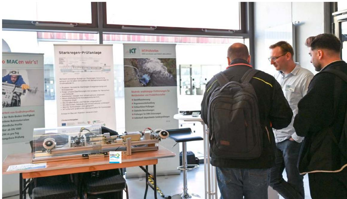
**Bild 30** *Simon Torunski (IKT) demonstriert, dass mit der Messtechnik der Micro-MAC-Prüfeinrichtung sogar in Glasrohren Verformungen und Steifigkeiten direkt messbar sind*
