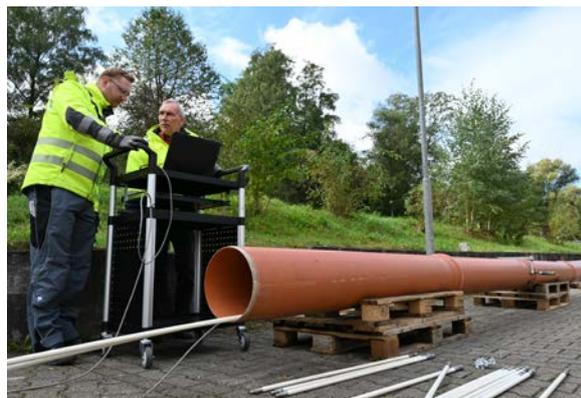
**Bild 15** Einsatz des Micro-MAC in der IKT-Versuchsstrecke DN 300: Positionieren des Micro-MAC (links) und Anfahren der Prüfstellen (rechts)
