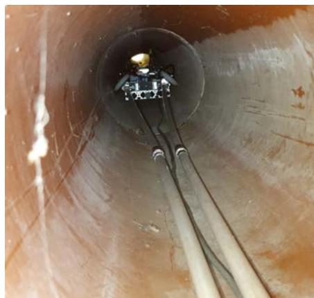
**Bild 16** Einsatz des Micro-MAC in der IKT-Versuchsstrecke DN 300: Prüfposition im Rohr (links) und Anfahren der Prüfstellen mit Schiebbestangen (rechts)
